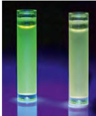
Angesichts sinkender Kältemittelfüllmengen in Fahrzeugklimaanlagen muss die Nachweisempfindlichkeit der Lecksuchtechnik weiter erhöht werden. Hier überzeugt die Qualitätsmarke TRACER® mit leuchtstarken Additiven und fortschrittlicher LED-Blaulicht-UV-Technologie.
