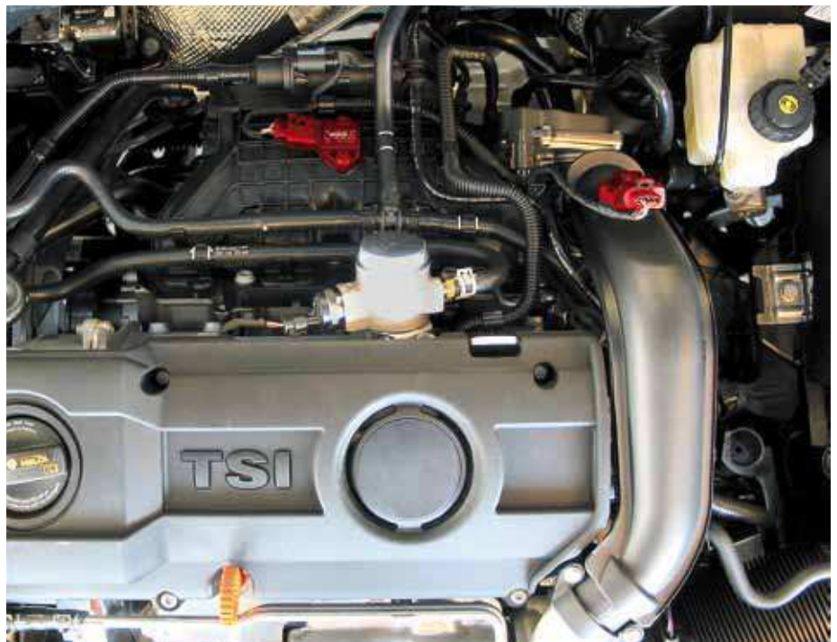
Saugrohrdrucksensor (links) und Ladedrucksensor (rechts) im VW Golf VI (rot hervorgehoben)
