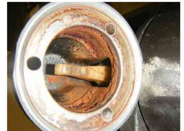
Korrosion im Inneren des Starters
