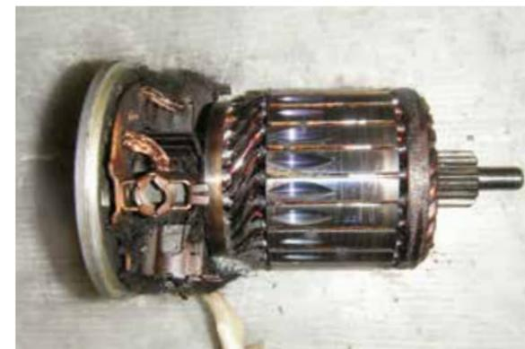
Anker des Starters thermisch überlastet (Verfärbungen)
