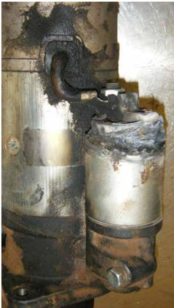
Kurzschluss (Brandspuren an Gehäuse)
