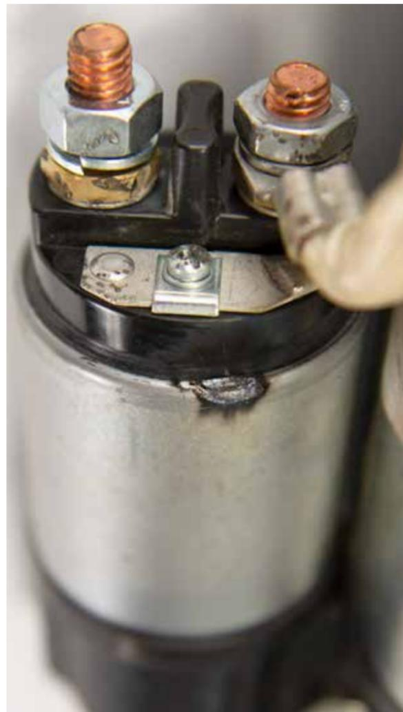
Kurzschluss (Brandspuren an Gehäuse)
