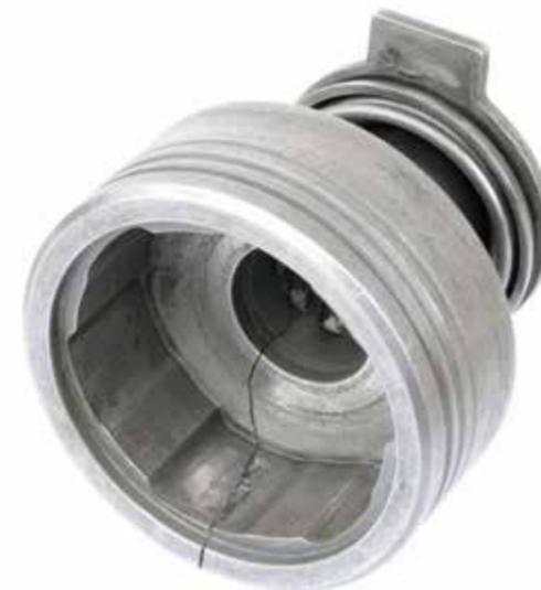
Gehäuse von Freilaufkupplung überlastet und gerissen
