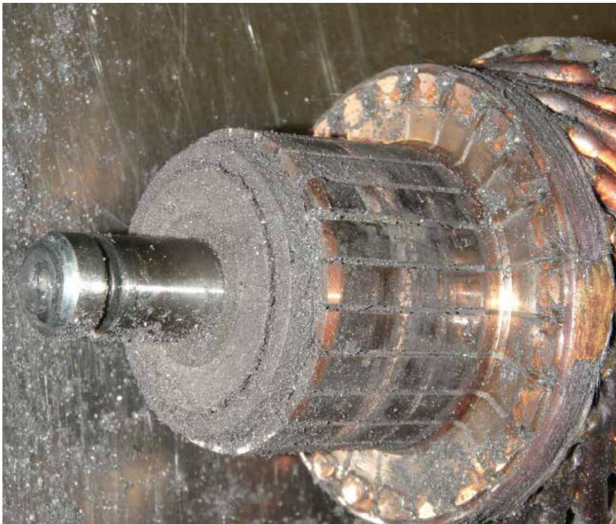
Abrieb der Kohlebürsten auf dem Kommutator
