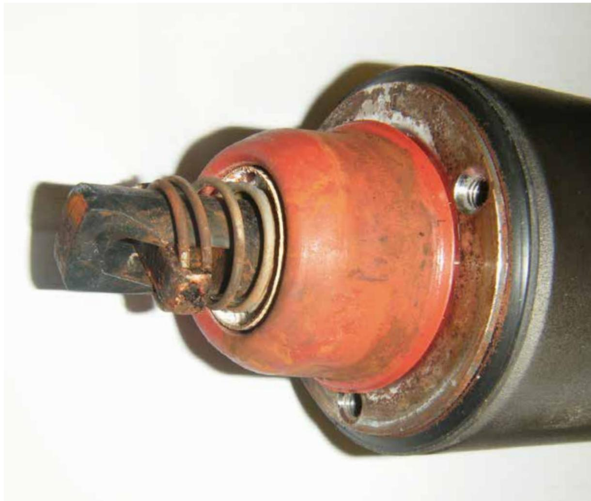
Korrosion am Magnetschalter
