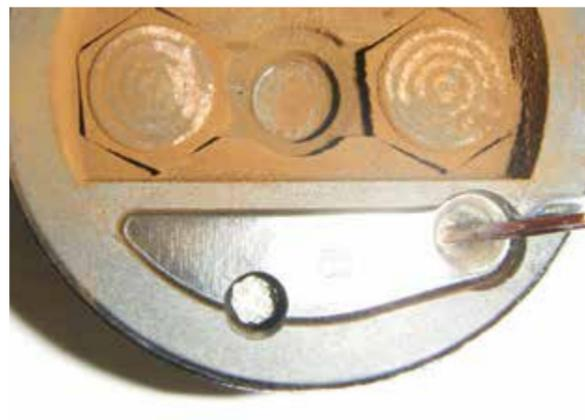
Korrosion an Kontakten
