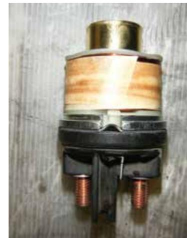
Magnetschalter überhitzt, Indikatorband leicht verfärbt
