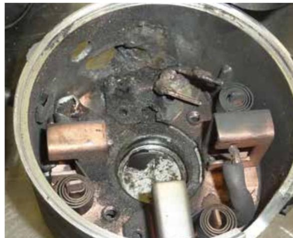
Zerstörter Bürstenhalter durch Ausschleudern (Überdrehzahlen) des Ankers
