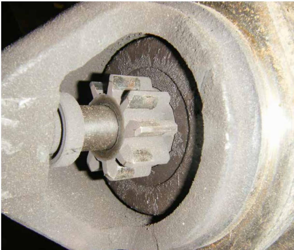
Starter und Freilaufkupplung stark verschmutzt
