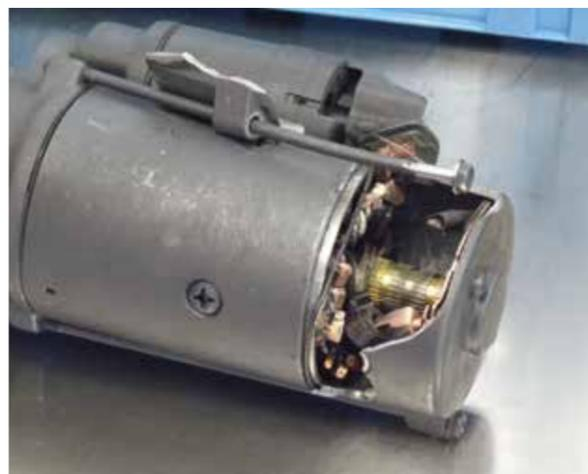
Hinterer Lagerdeckel gebrochen, Rotor und Kommutator ausgeschleudert
