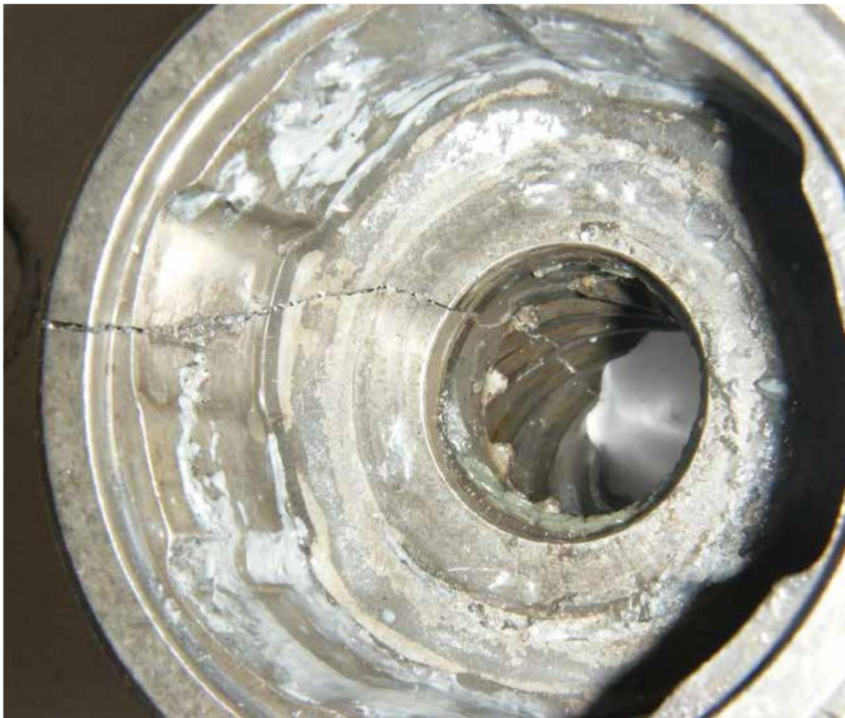
Gehäuse von Freilaufkupplung überlastet und gerissen
