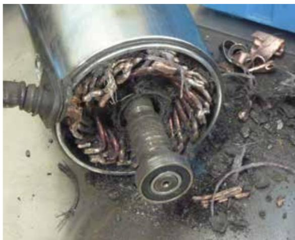
Kommutator total zerstört (extreme Überdrehzahlen)
