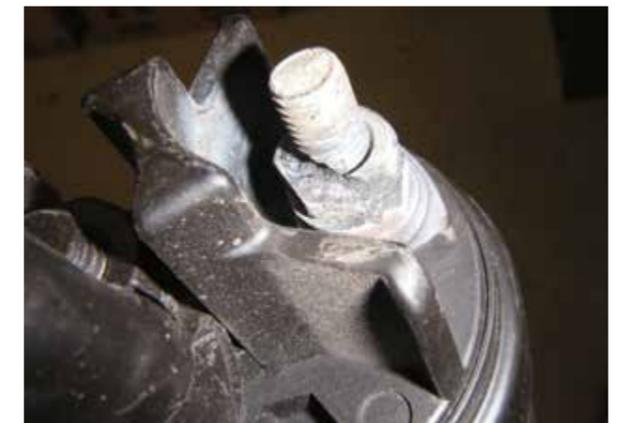
Kurzschluss an Magnetschalter
