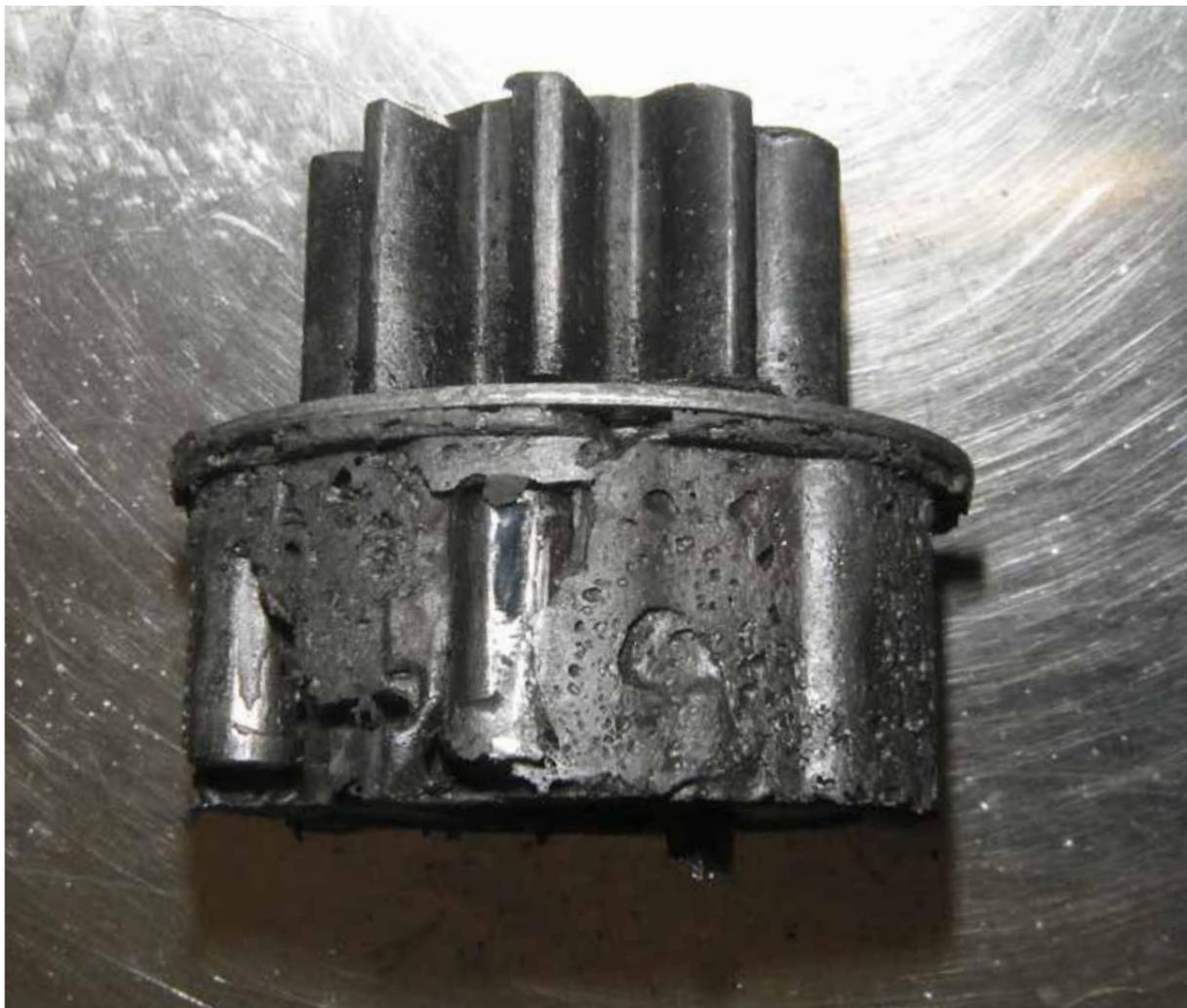
Ritzel mit Freilaufkupplung überhitzt, Wälzkörperkäfing geschmolzen
