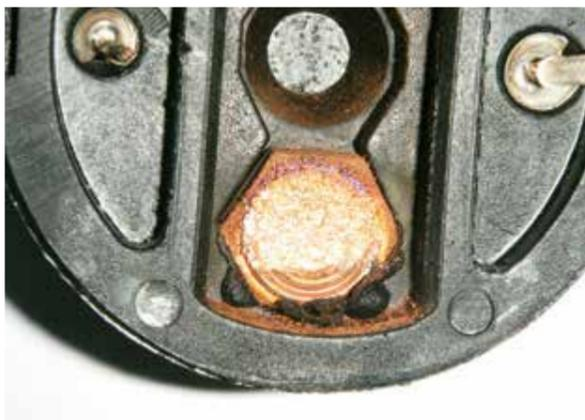
Kontaktschraube überhitzt und in Deckel eingeschmolzen
