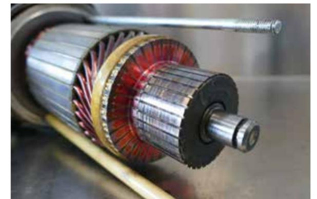
Brandspuren am Kommutator des Starters
