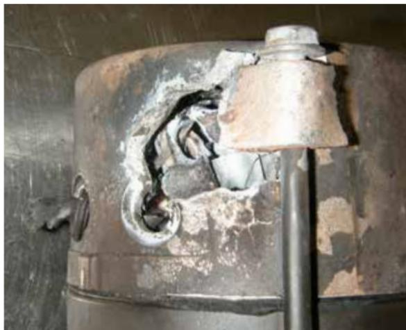
Hinterer Lagerdeckel des Starters durch Ausschleudern gebrochen und durch Kontakt mit der Bürste geschmolzen
