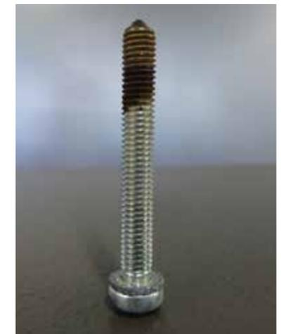
Befestigungsschraube des Magnetschalters mit Brandspuren von überhitzter Magnetspule
