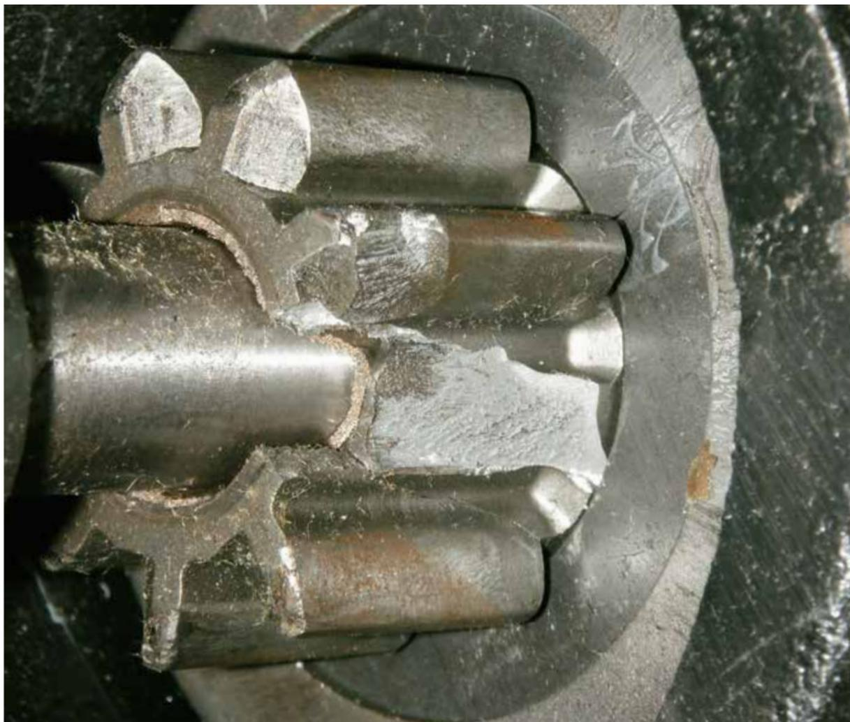
Ausgebrochener Zahn an Starterritzel (mechanische Überlastung)
