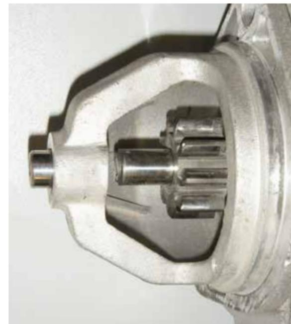
Starterwelle durch mechanische Überlastung gebrochen
