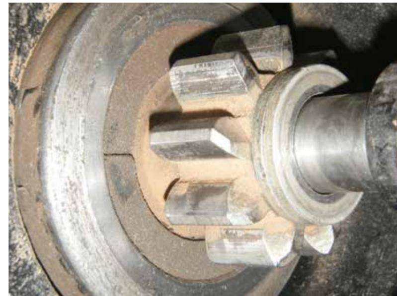
Schleifspuren von Schwungrad an Schutzblech der Freilaufkupplung
