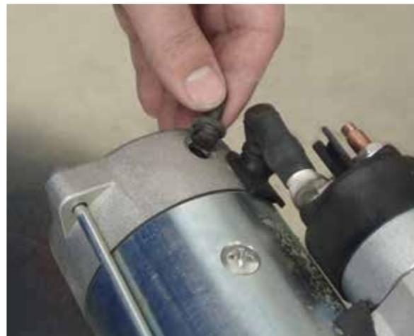
Blick in die Entwässerungsbohrung
