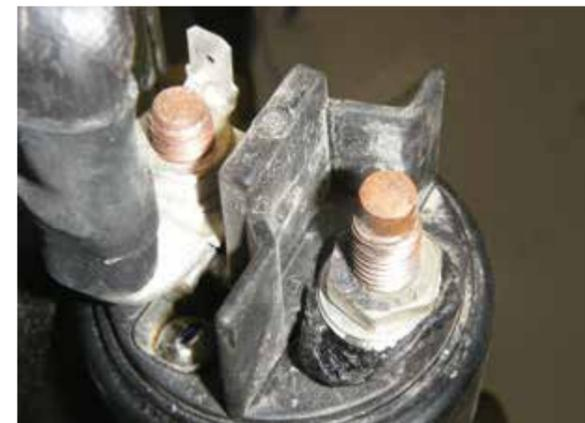
Gelöster Anschluss hat Schraube überhitzt (Gehäuse geschmolzen)
