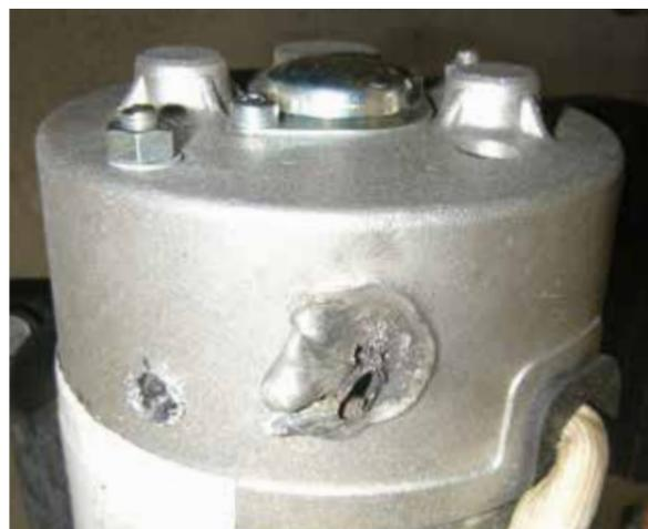
Hinterer Lagerdeckel des Starters durch Kontakt mit Bürste geschmolzen
