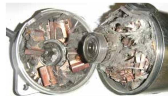
Ankerwicklung und Glasfaserring von Anker ausgeschleudert, Kommutator und Bürsten zerstört
