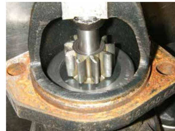
Korrosion am Starter
