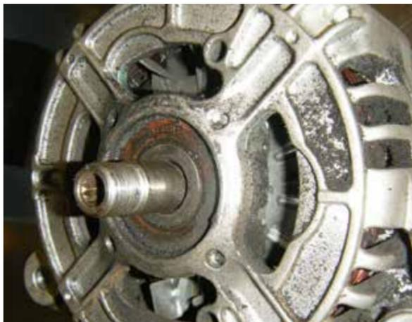
Deutlich sichtbarer Verschleiß der Welle im Bereich des Kugellagers (Mutter war lose). Durch das vergrößerte Spiel hat der Rotor am Stator geschliffen.
