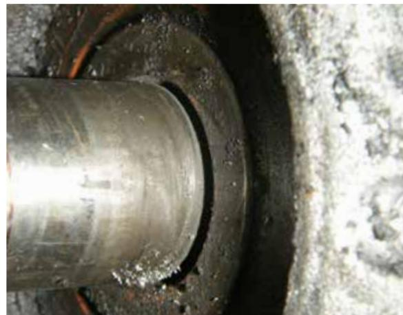
Deutlich sichtbarer Verschleiß der Welle im Bereich des Lagers (Mutter war lose)
