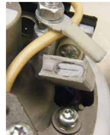
Abgebrochener Anschluss des Kondensators (z. B. Generator heruntergefallen)
