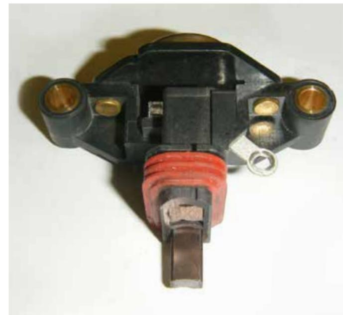
Kohle bei Demontage/Montage des Reglers abgebrochen
