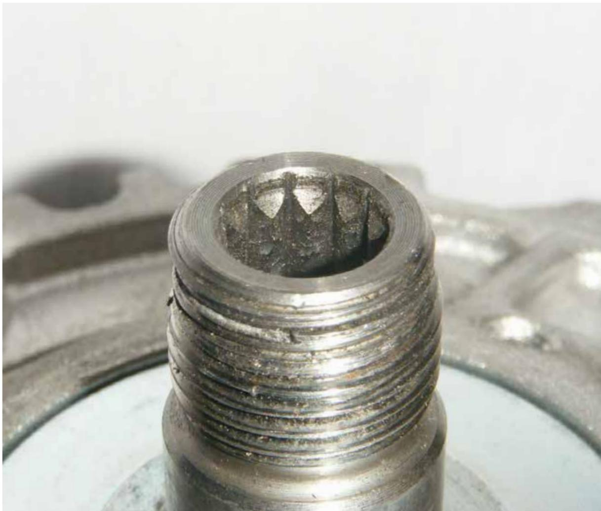
Gewinde an Generatorwelle stark beschädigt
