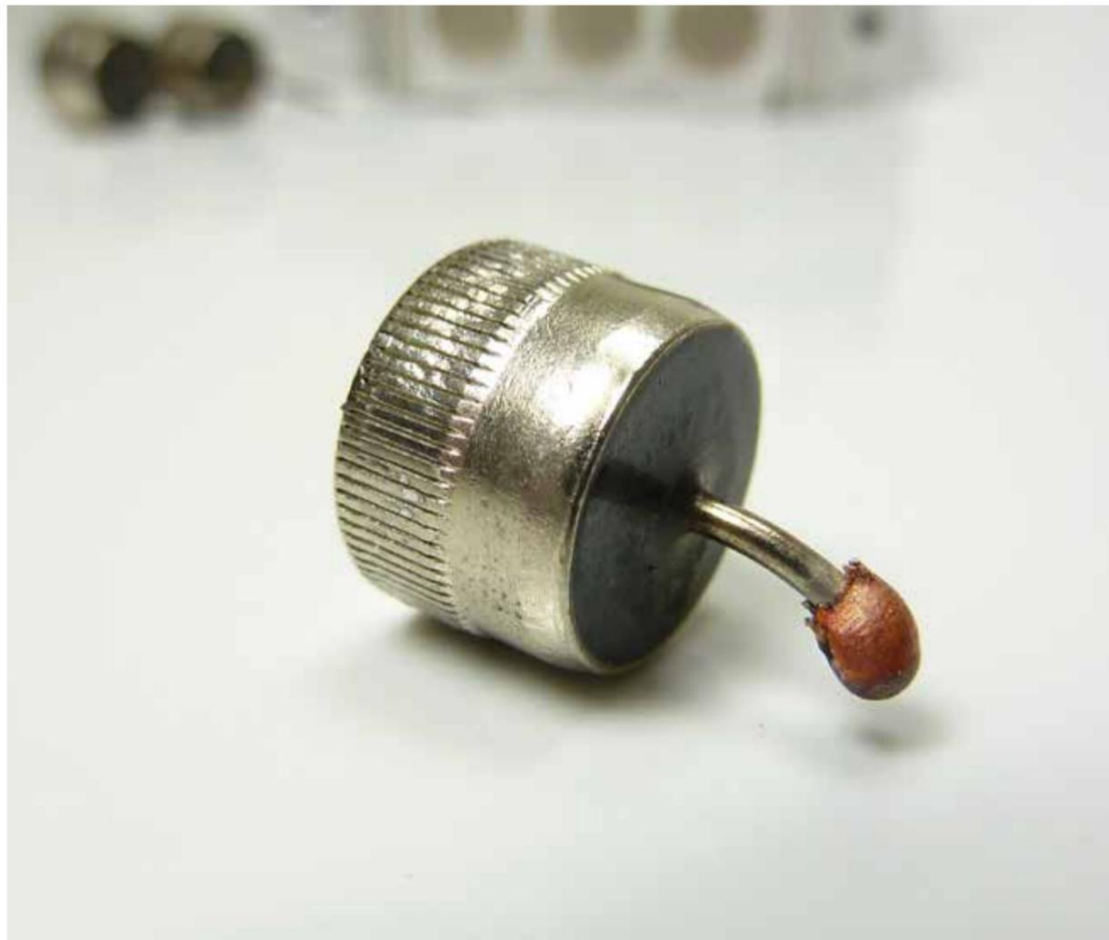
Anschluss der Leistungsdiode durch Kurzschluss geschmolzen
