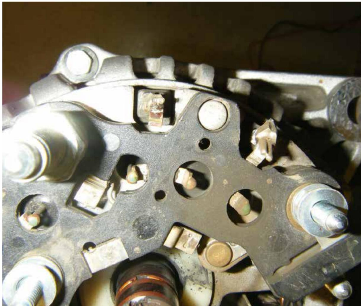
Durch starke Vibrationen des Motors gebrochene Lötstelle am Generator
