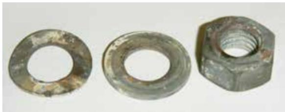
Brandspuren an Unterlagscheiben und Mutter
