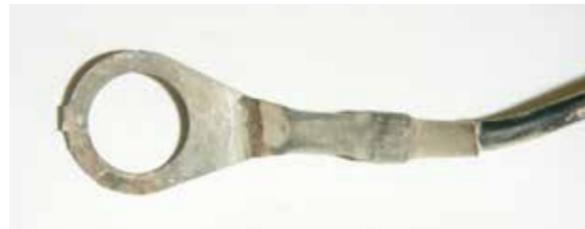
Kabelschuh mit Brandspuren
