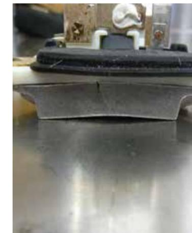
Reglergehäuse deformiert und gerissen (mechanische Überlastung)
