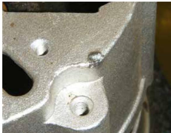
Spuren von Lichtbogen an Generatorgehäuse
