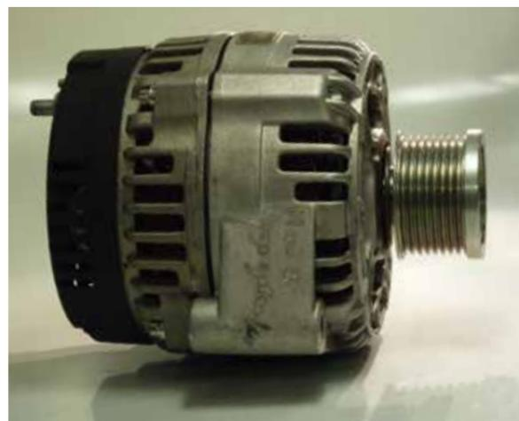
Generator mit vom Kunden montierter Freilaufriemenscheibe
