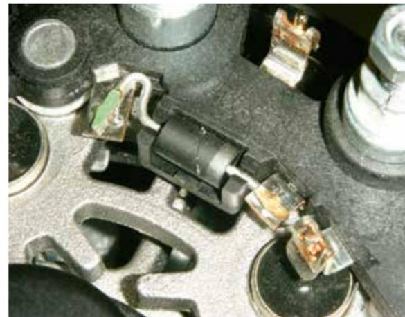
Durchgebrannte Erregerdiode (Kurzschluss)
