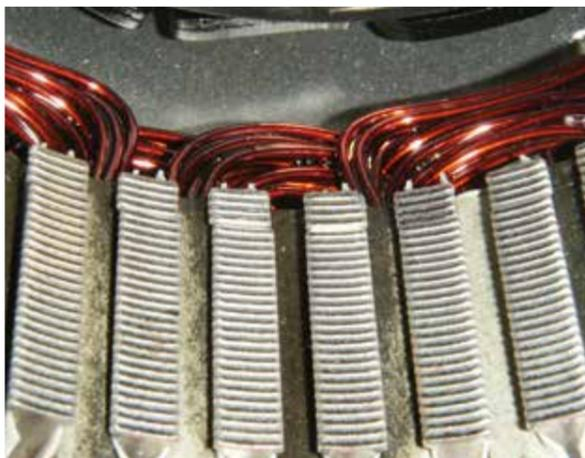
Blechlamellen im Inneren des Stators verschoben
