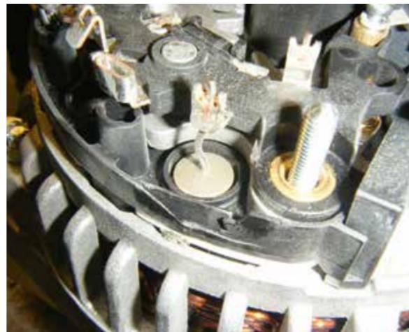
Mechanische Beschädigung an Leistungsdiode und Kunststoffhalter
