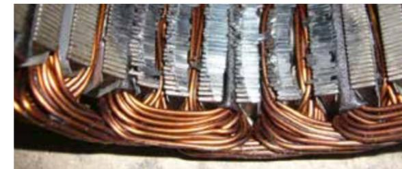
Schleifspuren des Rotors am Stator aufgrund von Wellenverschleiß
