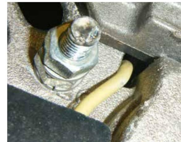
Anzeichen von Kurzschluss an Masseanschluss und an Reglergehäuse
