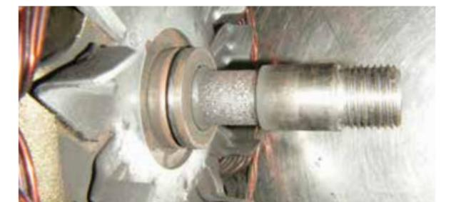
Welle im Bereich des vorderen Kugellagers stark verschlissen (Mutter war lose)
