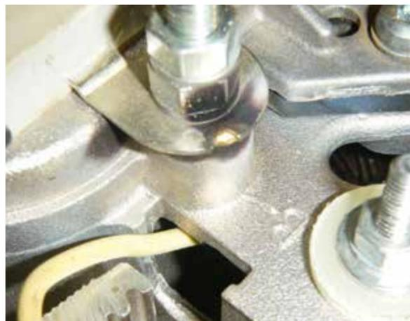
Brandspuren von Kurzschluss an Generatorgehäuse
