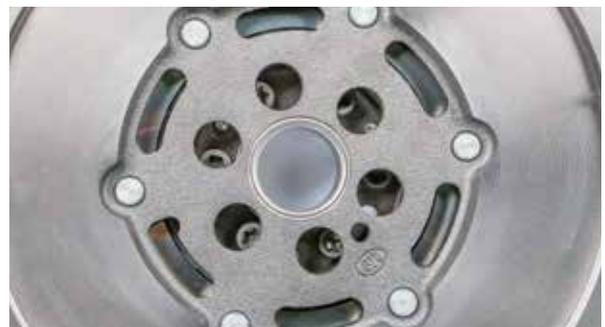
Stehen die Bohrungen versetzt zu den Schrauben, kann das ZMS bereits geschädigt sein. Hier wird eine genauere Prüfung mit dem LuK Spezialwerkzeug, Art.-Nr.: 400 0080 10, empfohlen.
