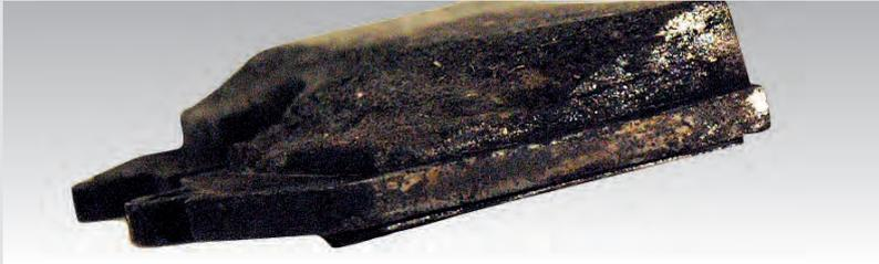
► Deutliche Beschädigung durch äußere Einwirkung
