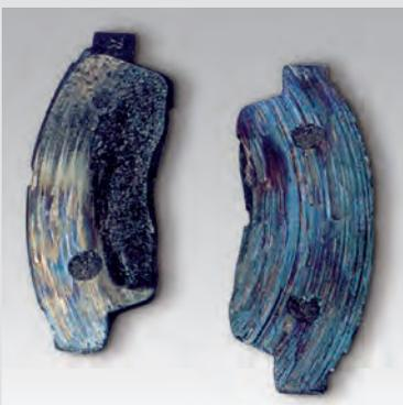
► Reibwerkstoff bis auf den Stahlträger verschlissen
