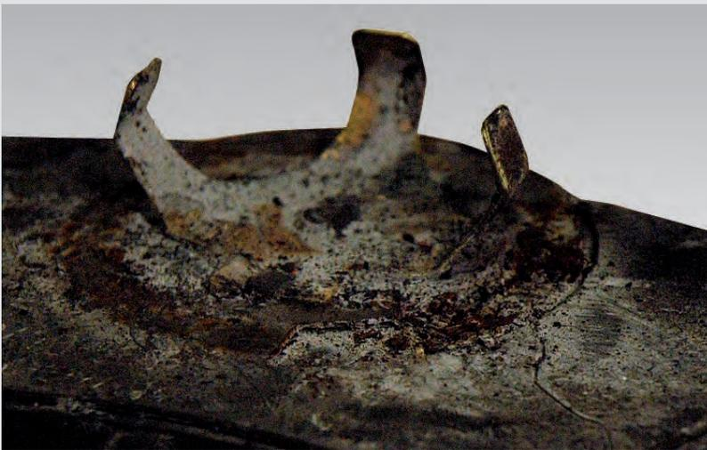
► Aussparung im Dämmblech durch Verunreinigung außer Funktion
