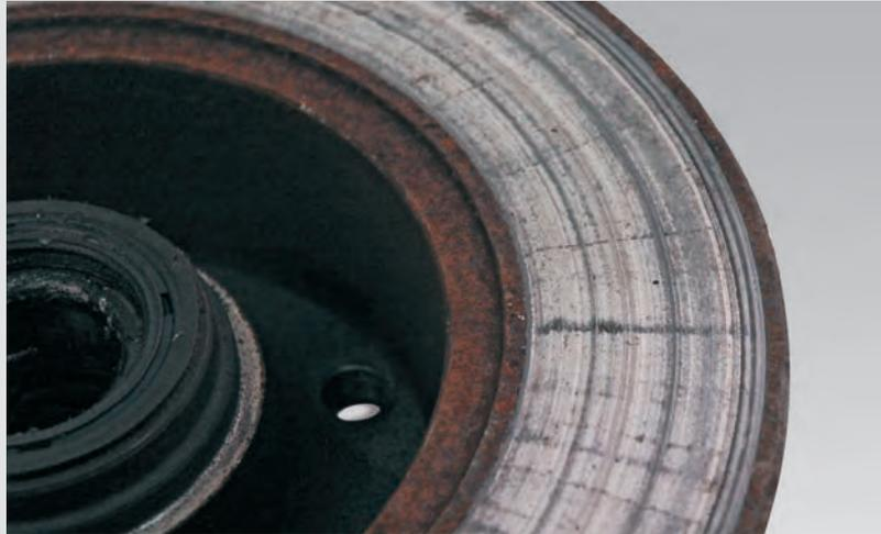
► Korrodierte Bremsscheibe
