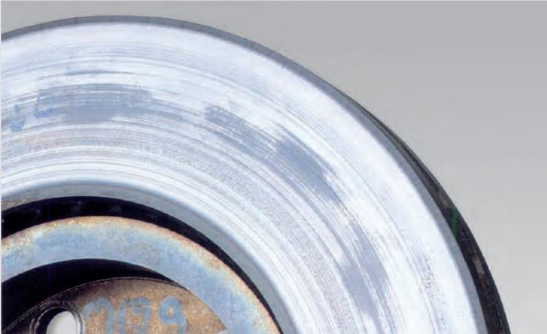
► Örtlich überhitzte Bremsscheibe mit „Rubbleflecken“
