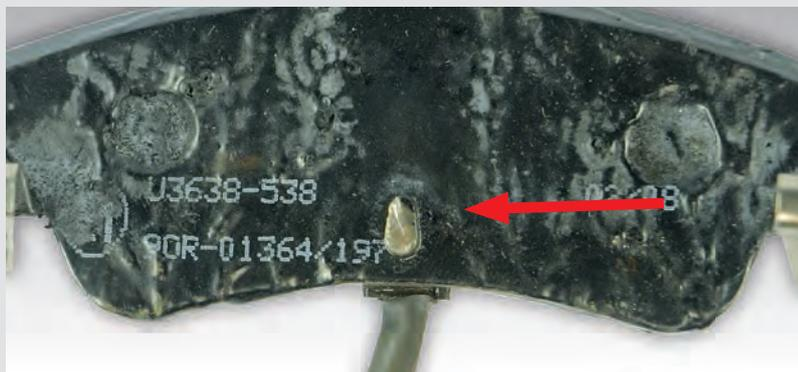
► Kolbenabdruck an der Verdrehsicherung
