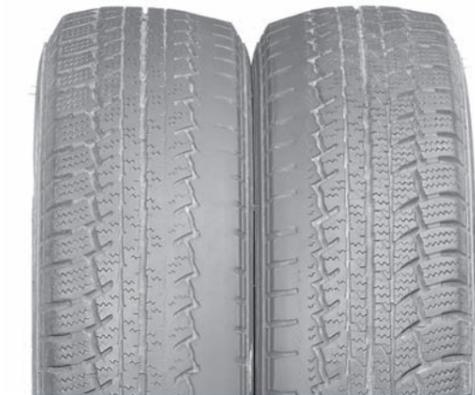
Durch „Schräglauf“ der Räder erhöhter und einseitiger Verschleiß. Häufig in Verbindung mit Gratbildung an Profilkanten bis hin zu abgefahrenen Schulterkanten.
