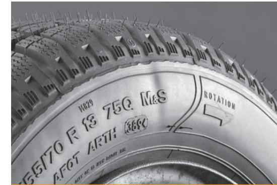
Einschnürung durch Überlappungsnaht der Karkasslage
