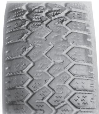
Extremer Verschleiß durch Vollbremsung (ohne ABS).
