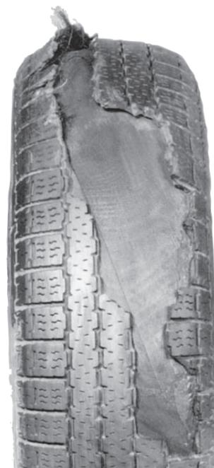
Abriss einzelner Reifenteile als Folge von Wartungsmängeln.
