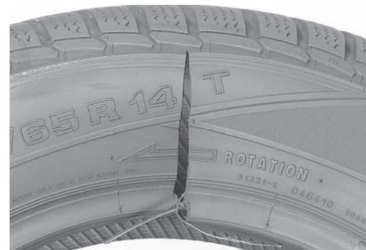
Gebrochener Kern durch zu hohe Zugspannung beim Füllvorgang.
