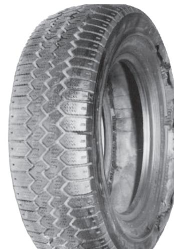
Starke Erwärmung wegen Fahrens mit erheblichem Minderdruck führte zu Separationen zwischen den Aufbauteilen und zu Verschmorungen des Gummimaterials.
