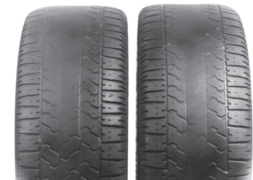
Beispiel für ein Abnutzungsbild von Reifen auf der Antriebsachse eines leistungsstarken Pkw: deutlich sichtbarer Verschleiß in der Mitte der Lauffläche.
