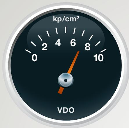
Wenn der Öldruck zu hoch ist, können Gehäusedichtungen, Ölfilter, Ölkühler und Leitungen undicht werden oder bersten.
