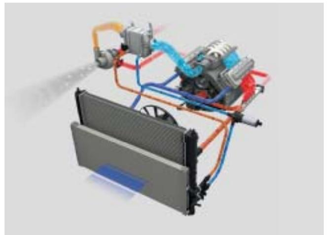
Ladeluftführung bei Ladeluft-/Kühlmittel-Kühlung (indirekte Ladeluftkühlung)
