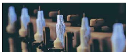
Isolatorenprüfung bei 40.000 Volt: Auf Prüfständen müssen Beru Zündkerzen ihre Zuverlässigkeit vor dem Serienanlauf unter Beweis stellen.
