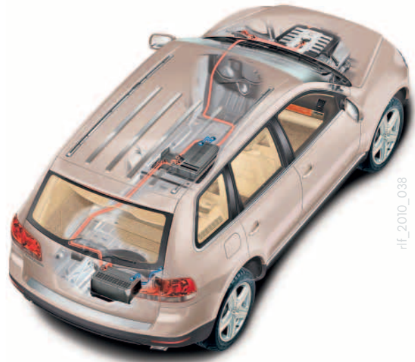
Abb.: Beispiel für ein Fahrzeug mit Zwei-Batterie-Konzept (Batterien im Motor- und Kofferraum)
