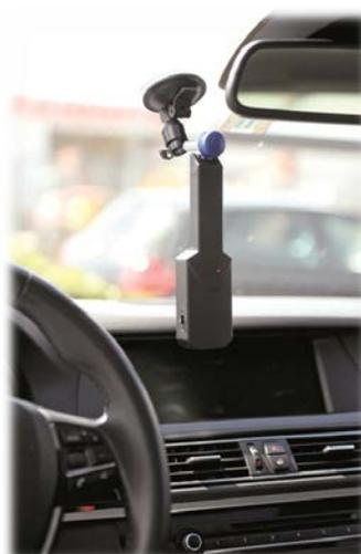
Das System besteht aus mobilen Alarmgebern, die in den Fahrzeugen positioniert werden, einem Repeater und Empfänger. Erschütterungen am Fahrzeug werden vom Alarmgeber erkannt und an den Empfänger gemeldet.
