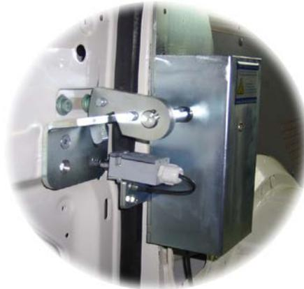
Keine Beschädigung in der Außenhaut der Fahrzeuge durch Bohrlöcher. Das Riegelsystem GWS2 arbeitet völlig autark. In Verbindung mit dem Steuermodul **GWS1** wird die Sicherheit des Fahrzeugs erhöht, durch:
