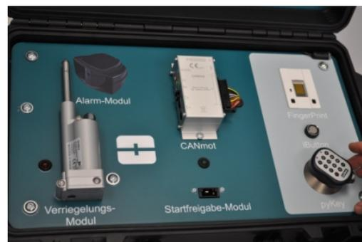
↑ Systemübersicht mit integrierter zweistufiger Alarmanlage
