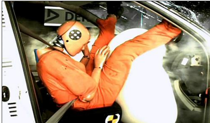
Abb. 4 : Crashtest mit Füßen auf dem Armaturenbrett
