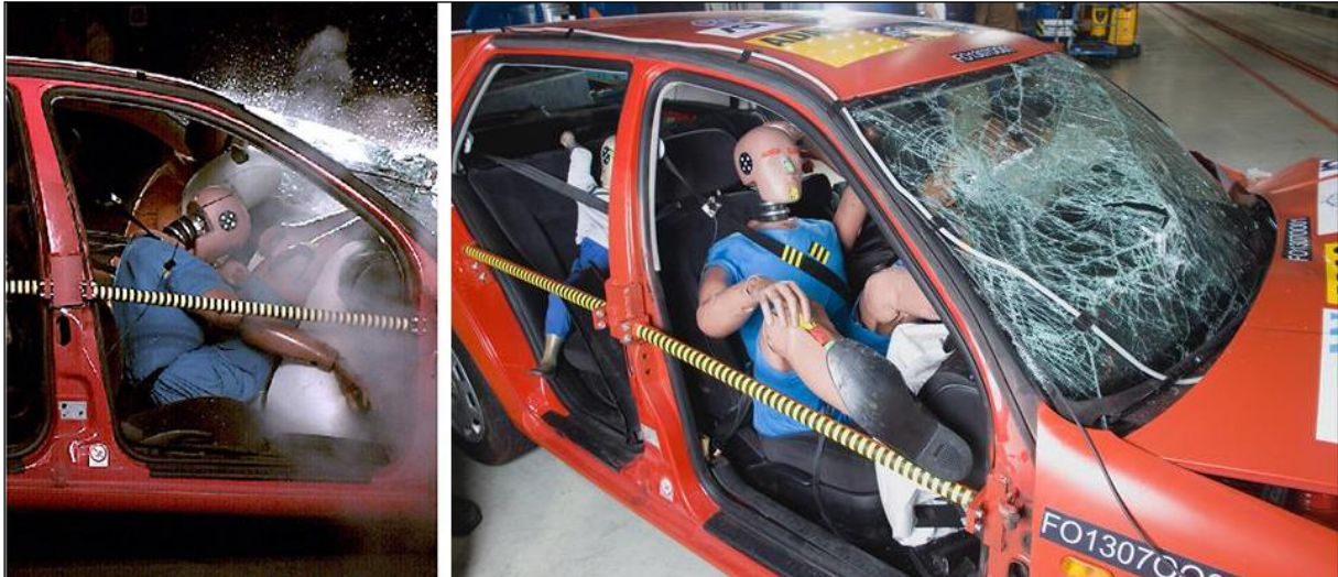
Abb. 1 & 2: Crashtest mit Füßen auf dem Armaturenbrett
