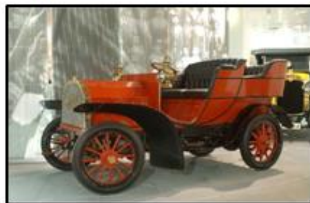
Abb. 3: Der Horch 10: Das erste Auto mit einer Vierradbremse
