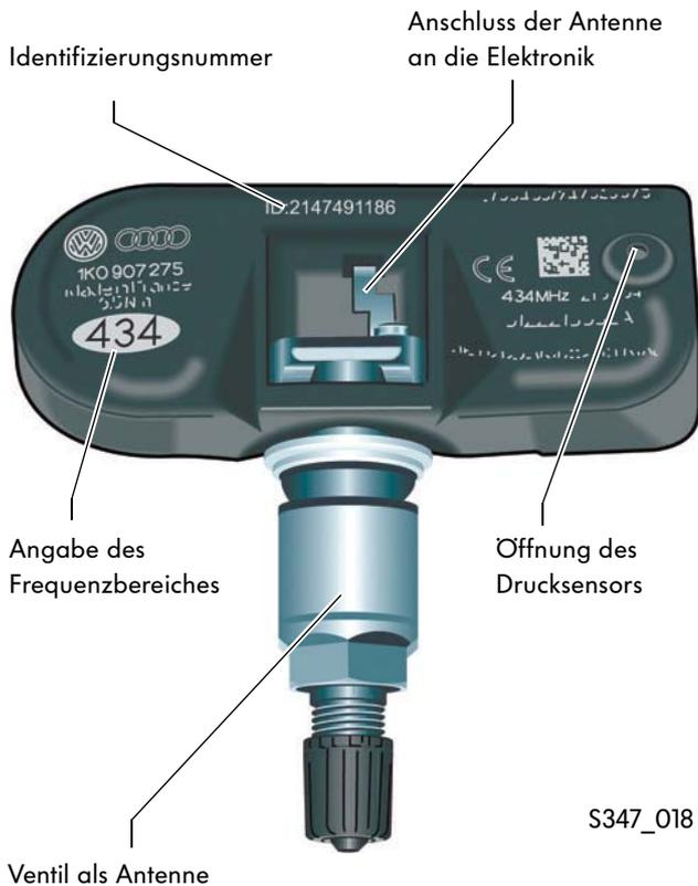
Die Radelektroniken der RDK ohne Positionserkennung sind anders aufgebaut als die der RDK mit Positionserkennung im Touareg und Phaeton. Sie beinhalten folgende Komponenten:
