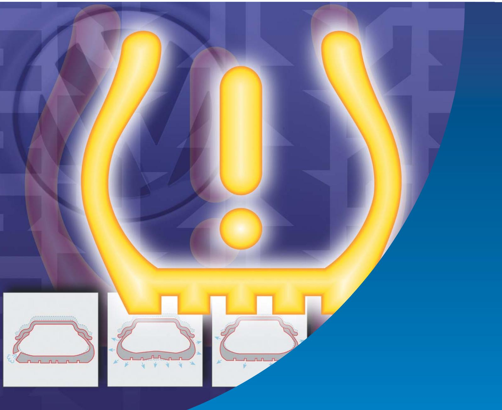
Reifendruck-Kontrollsysteme überwachen den Luftdruck der Reifen. Sie können vor gefährlichen Druckveränderungen warnen und einen Hinweis ausgeben, wenn der Ist-Reifendruck vom Soll-Reifendruck abweicht.
