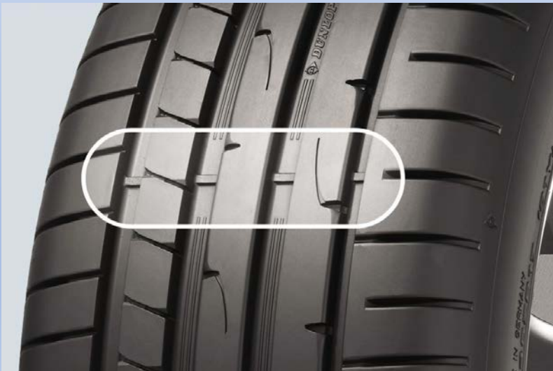
1 — Hauptprofil: Breite Profiltrillen im mittleren Bereich der Lauffläche
