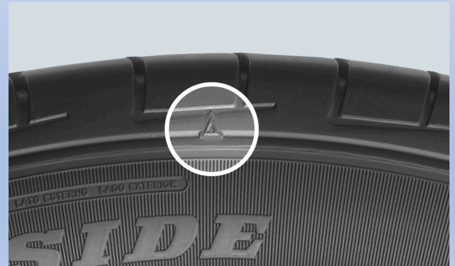
2 — Position der TWI's: Markierung auf der Reifenflanke
