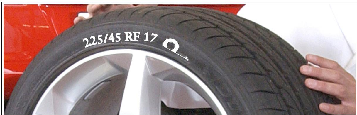
Abbildung 5-3: Reifenkennzeichnung eines Runflat-Reifens
