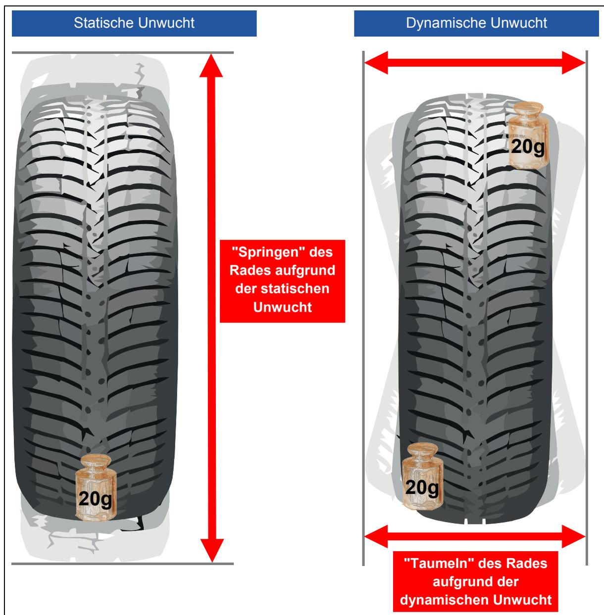
Abbildung 3-1: Statische und dynamische Unwuchten an Rädern
