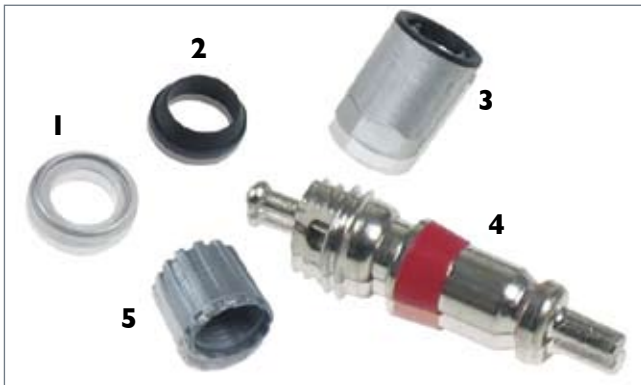
Abb. 4: Beispiel Service-Kit für RDKS-Sensor mit Metall-Schraub-Ventil. 1 – Dichtscheibe, 2 – Dichtring, 3 – Befestigungsmutter, 4 – Ventileinsatz, 5 – Ventilkappe.
