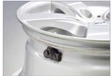
Eingebauter OE-Sensor von Huf.
