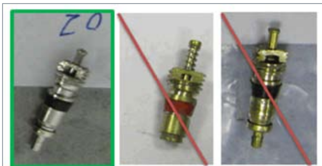
Abb. 5: Achtung - nur vernickelte Ventileinsätze verwenden (sonst Korrosionsgefahr)!
