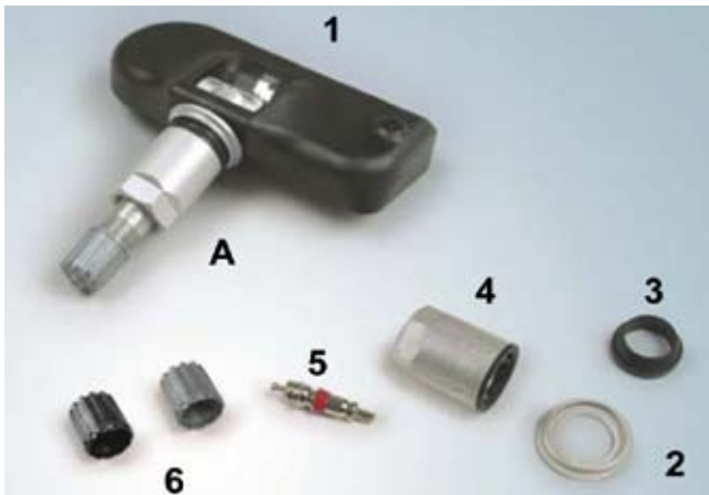
Abb. 3: Beispiel für einen RDKS-Sensor mit Metall-Schraub-Ventil. 1 – Sensor mit (A) Ventilschraube, 2 – Dichtscheibe, 3 – Dichtring, 4 – Befestigungsmutter, 5 – Ventileinsatz, 6 – Ventilkappe.
