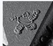
Für Winterreifen gibt es zusätzlich Abnutzungsindikatoren, die in manchen Ländern vorgeschrieben sind und eine Mindestprofiltiefe für Winterreifen von 4 mm anzeigen. Bei Michelin ist die Position dieser Indikatoren durch eine Schneeflocke im Schulterbereich gekennzeichnet.
