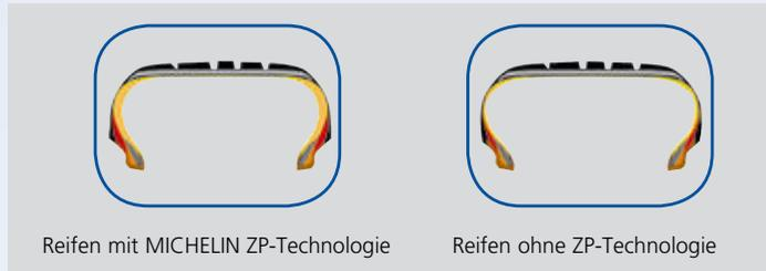
Innovation im Flankenbereich: Robustere Flanken und eine spezielle Gummimischung sorgen auch bei völligem Druckverlust dafür, dass der Reifen tragfähig bleibt.
