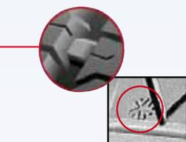
**Verschleißanzeiger 4 mm:** Verschleißanzeiger, die erscheint, sobald ein Restprofil von 4 mm erreicht ist. Bei MICHELIN Winterreifen zeigt ein Schneeflockensymbol auf der Reifenflanke die Lage der Verschleißanzeiger für Winterreifen an.
