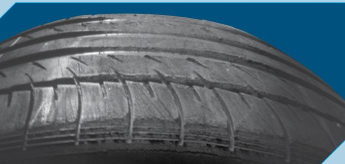
und lokal abgeschliffen werden. In der Regel ist das durch starke Vibrationen im Lenkrad zu spüren, sodass die betroffenen Reifen ausgetauscht werden müssen. Insbesondere beim Bremsen aus hohen Geschwindigkeiten kann auch ein ► [ABS-System S. 7](#), das Entstehen von Bremsplatten nicht vollständig verhindern.
