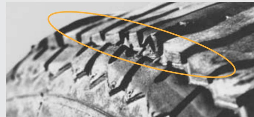
Bei grobstolligen oder zu den Seiten hin offenen Profilen kann es vor allem an den Rädern der nicht angetriebenen Achse zu einer schrägen Abnutzung in den Schulterbereichen kommen. Die Klötze verschleifen in Drehrichtung des Reifens im hinteren Bereich stärker als im vorderen. Dadurch ist bei seitlicher Betrachtung ein sägezahnförmiges Bild erkennbar.
