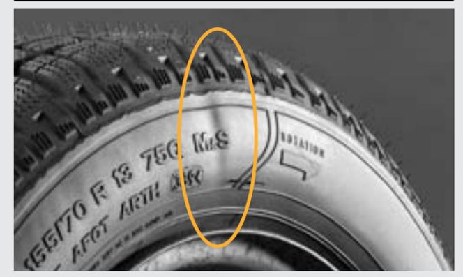
Einschnürung durch Überlappungsnaht der Karkasslage.
