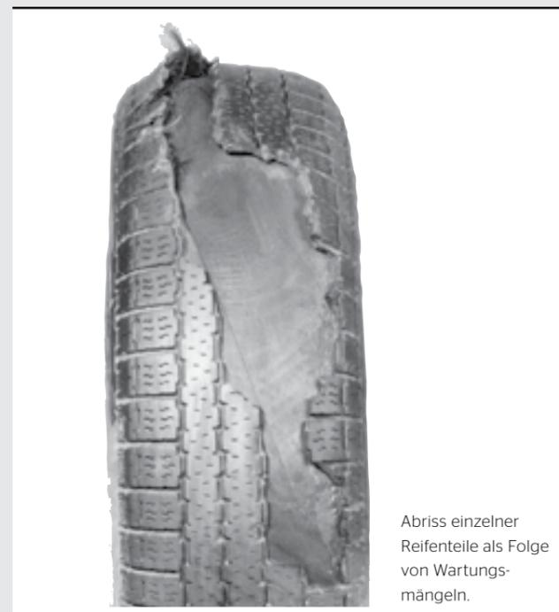
Abriss einzelner Reifenteile als Folge von Wartungsmängeln.
