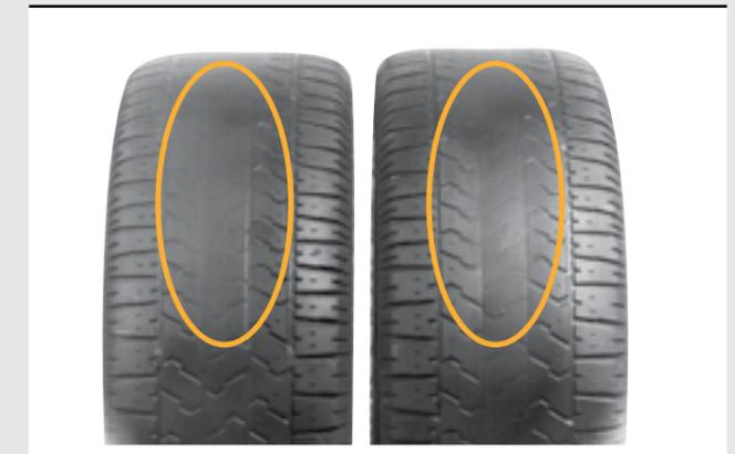
Beispiel für ein Abnutzungsbild von Reifen auf der Antriebsachse eines leistungsstarken Pkw: deutlich sichtbarer Verschleiß in der Mitte der Lauffläche.
