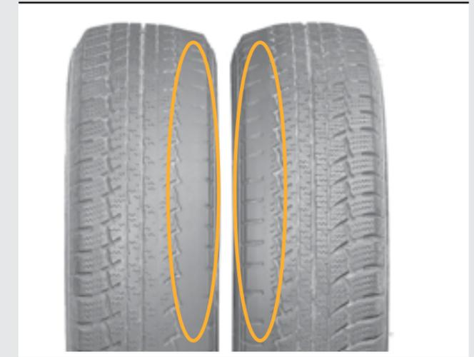
Durch „Schräglaufl“ der Räder erhöhter und einseitiger Verschleiß. Häufig in Verbindung mit Gratbildung an Profilkanten bis hin zu abgefahrenen Schulterkanten.
