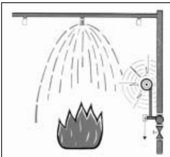
Prinzip einer Sprinkleranlage – ortsfeste Löschanlage
