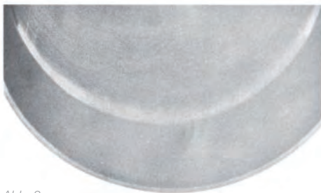
Abb. 2 Glänzende, umlaufende Linie an der Zylinderbohrung
