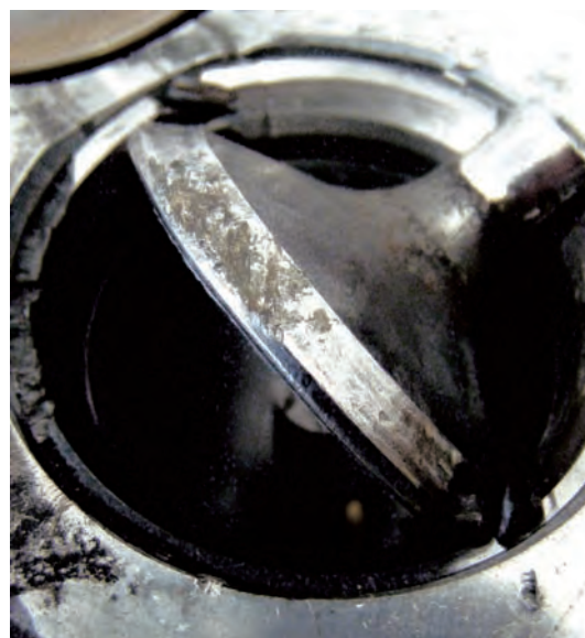
Abb. 1 Im Bereich des Ventiltellers abgerissenes Ventil
