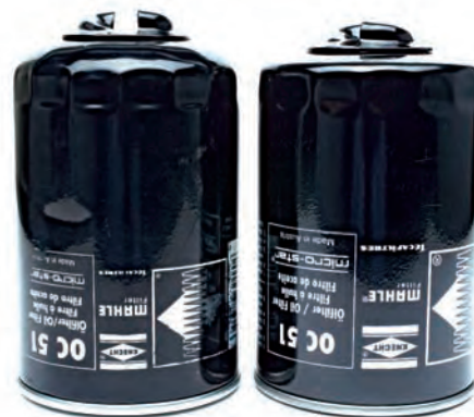
Abb. 2 Im Vergleich: aufgeblähter Filter (links) und neuer Filter (rechts)
