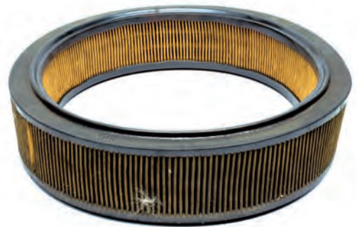
Abb. 3a Stark verschmutzter Luftfiltereinsatz, Wechsel unbedingt erforderlich
