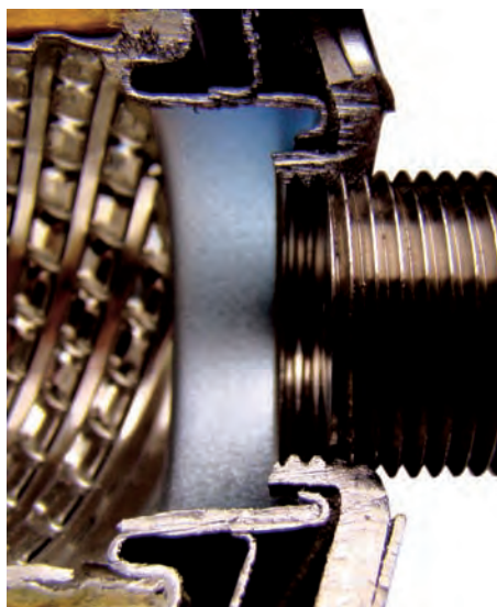
Abb. 2 Zu kurzes Gewindestück durch gelöste Kontermutter
