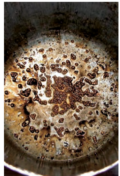
Abb. 3 Granulat, Wasser und Öl in der Lufttrockner-Patrone
