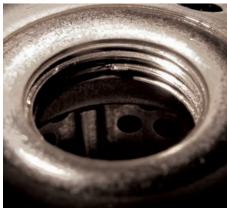
Abb. 5 Beschädigte Gewindegänge aufgrund eines schräg angeschraubten Filters
