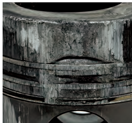
Abb. 1 Abschmelzungen am Feuersteg eines Dieselkolbens
