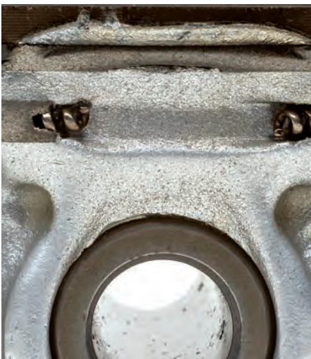
Abb. 1b Nahaufnahme der Oberflächen von weicherem Kolbenmaterial und härterem Kolbenringwerkstoff, in gleichem Maße abgetragen
