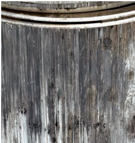
Abb. 1 Einseitiger Fresser auf der Druckseite am Kolbenschaff
