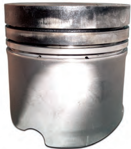
Abb. 1 Unsymmetrisches Tragbild (Schieflauf) am Kolbenschaft
