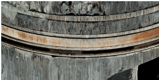
Abb. 2 Riefen und brandige Stellen an Kolbenringen
