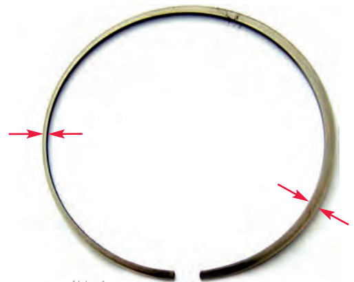
Abb. 1 Kolbenring mit extremem Radialverschleiß
