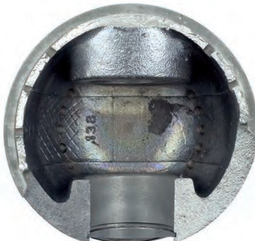
Abb. 3 Quer auf Höhe der Kolbenbolzenachse abgebrochener Kolben
