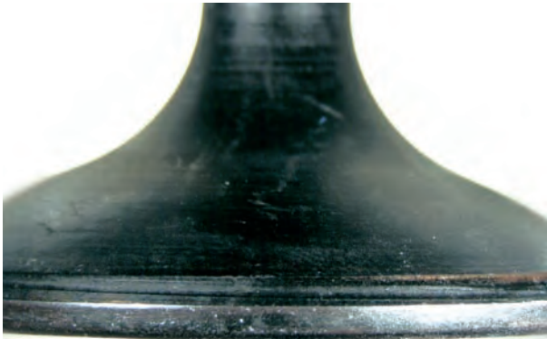
Abb. 1 Deformierter Ventilteller (Tulpenform)
