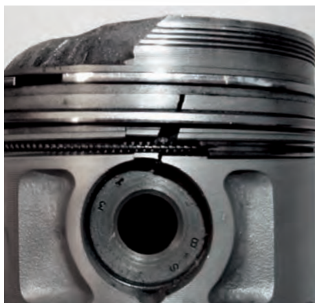
Abb. 3a Gewaltbruch vom Kolbenboden bis zur Nabenbohrung
