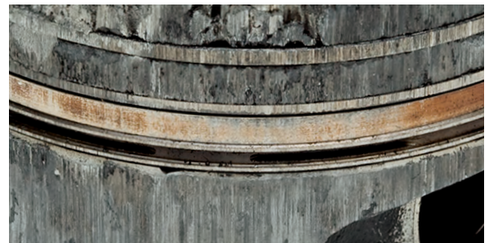
Abb. 2 Riefen und brandige Stellen an Kolbenringen
