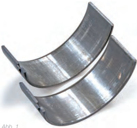
Abb. 1 Glänzende Stellen an den Laufflächen der Lagerschalen
