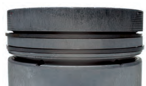
Abb. 2 Starker Axialverschleiß besonders am 1. Kolbenring
