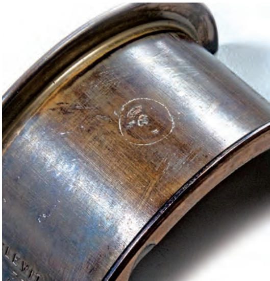
Abb. 2 Fremdkörperabdruck an der Gleitlager-Außenseite
