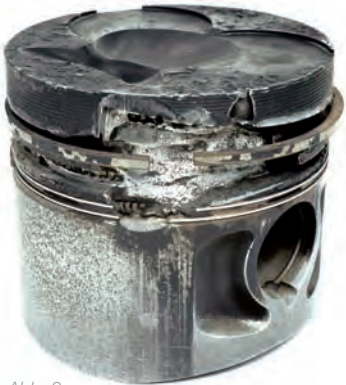
Abb. 2 Kolbenringzone mit blanker Oberfläche
