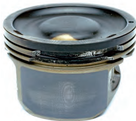
Abb. 1a Gebrochene Kolbenringstege durch Störung im Verbrennungsprozess
