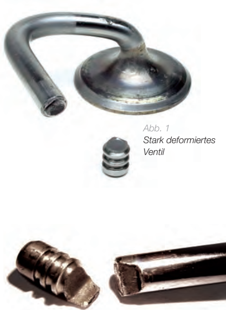
Abb. 2 In der Rille gebrochener Ventilfuß (Gewaltbruch/Biegebeanspruchung)
