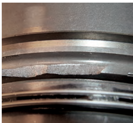
Abb. 2 Gebrochene Kolbenringstege durch Montagefehler
