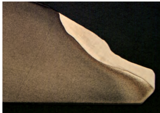
Abb. 3 Extrem abgenutzte Dichtfläche (stellitgepanzert)
