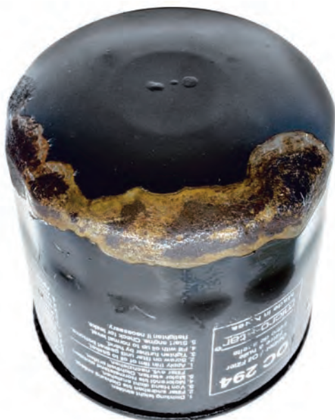
Abb. 4 Beschädigte Beschichtung – die Folge: Korrosion
