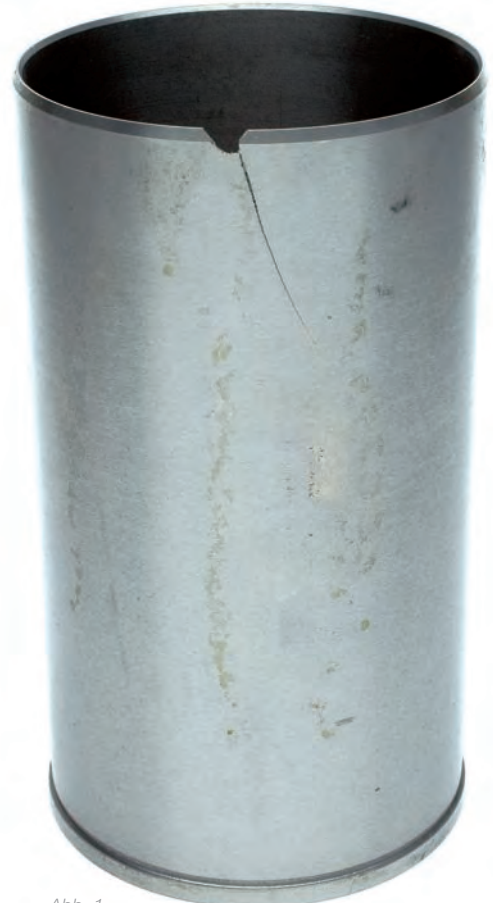
Abb. 1 Unteres Ende der Zylinderlaufbuchse mit Längsriss
