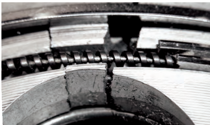
Abb. 3b Nahaufnahme eines Gewaltbruchs
