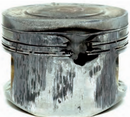
Abb. 4 Durchgeschmolzene Ringzone am Ottokolben
