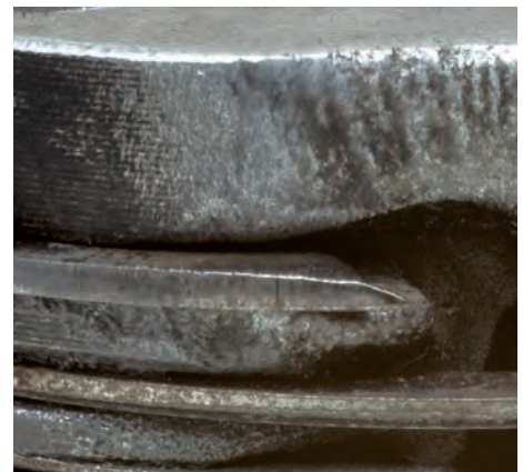
Abb. 1 Erosionsspuren am Ottokolben
