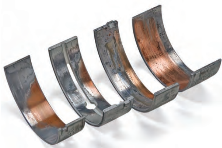
Abb. 1 Ungleichmäßiger Verschleiß an den Pleuellagern
