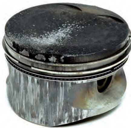
Abb. 3 Starke Erosionsspuren und Abschmelzungen am Kolbenkopf
