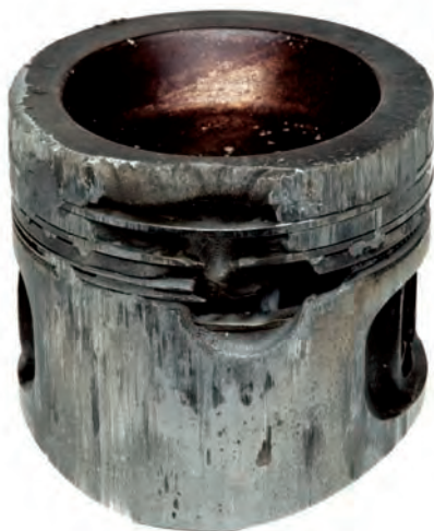
Abb. 2 Abgeschmolzener Feuersteg am Ottokolben
