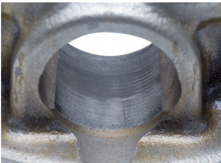
Abb. 3 Nabenbohrung mit Fressspuren
