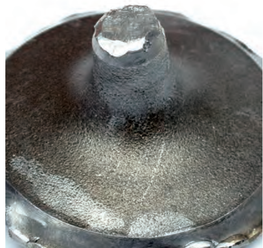
Abb. 3 Schwingungsbruch mit Bruchfläche am Ventilschaft
