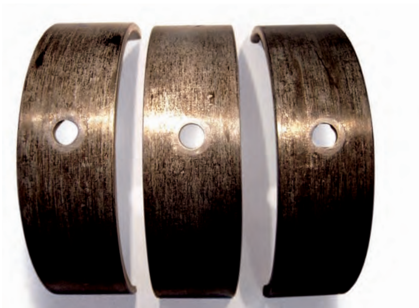
Abb. 1 Polierte Stellen an der Außenseite der Gleitlager
