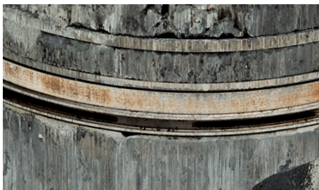
Abb. 2 Riefen und brandige Stellen an Kolbenringen
