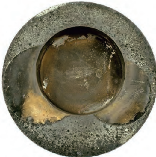
Abb. 2 Gegen Zylinderkopf gelaufener Kolben
