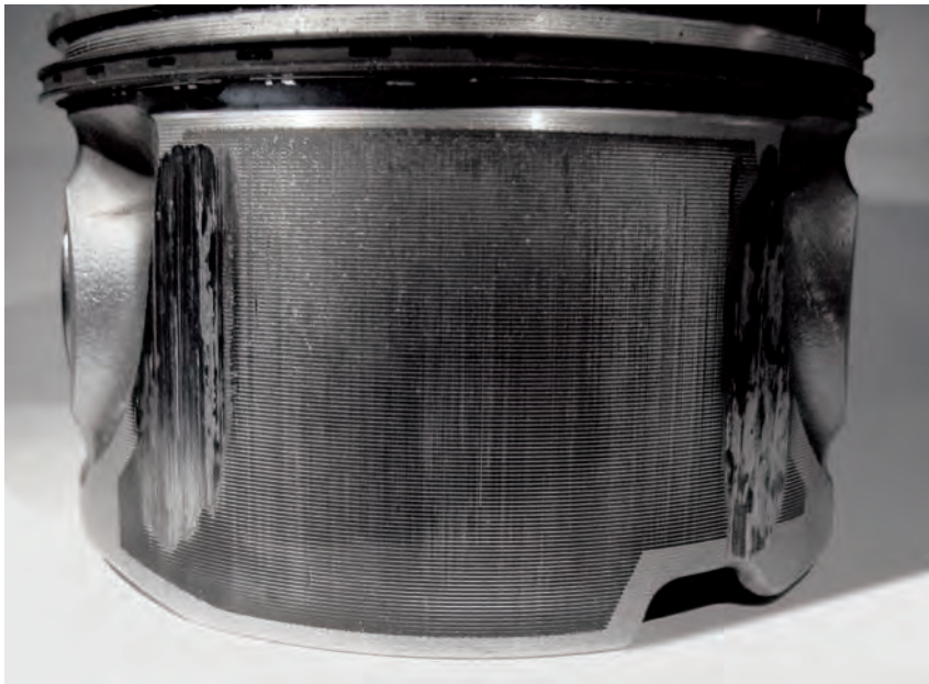
Abb. 2 Seitliche Kolbenfresser neben der Nabenbohrung
