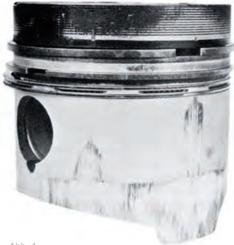
Abb. 1 Fresser am unteren Kolbenschaft durch Einschnürung der Zylinderlaufbuchse
