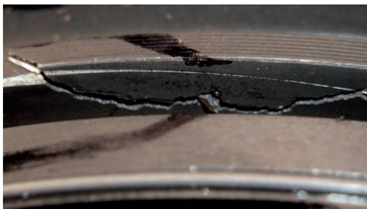
Abb. 3 Montagefehler mit Abdruck des Kolbenrings
