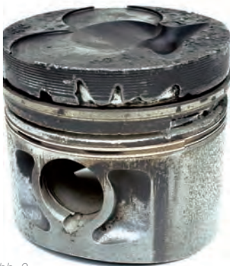
Abb. 3 Beschädigungen des Kolbenbodens durch einzelne Bruchstücke des Ringträgers
