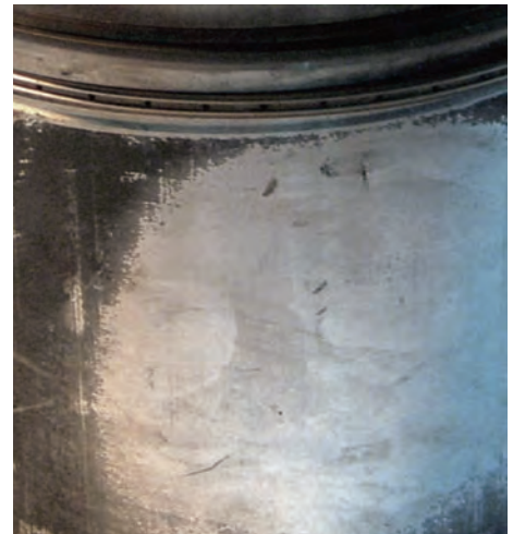
Abb. 1 Breites Tragbild und Riefen durch Kraftstoffverdünnung
