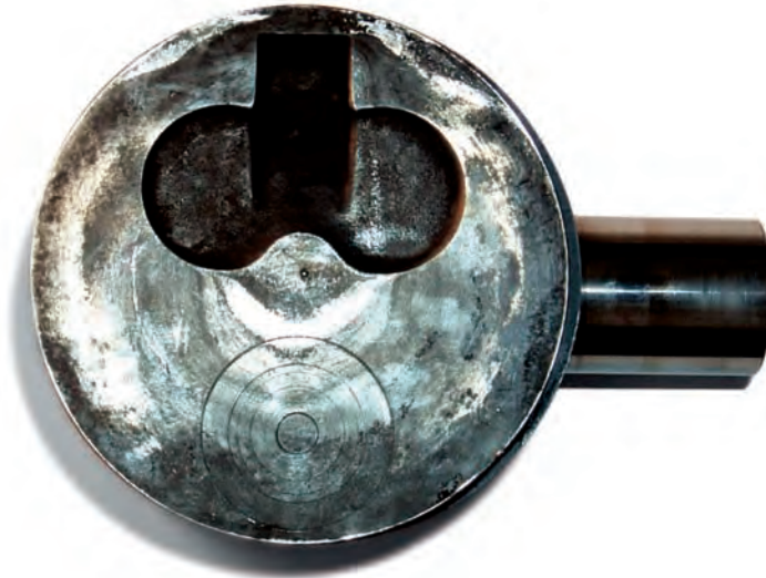
Abb. 1 Kolbenboden mit Ventilaufschlag
