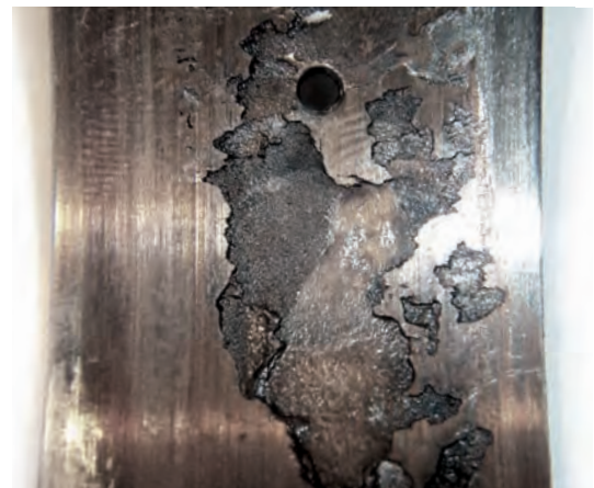
Abb. 1b Nahaufnahme der beschädigten Lauffläche
