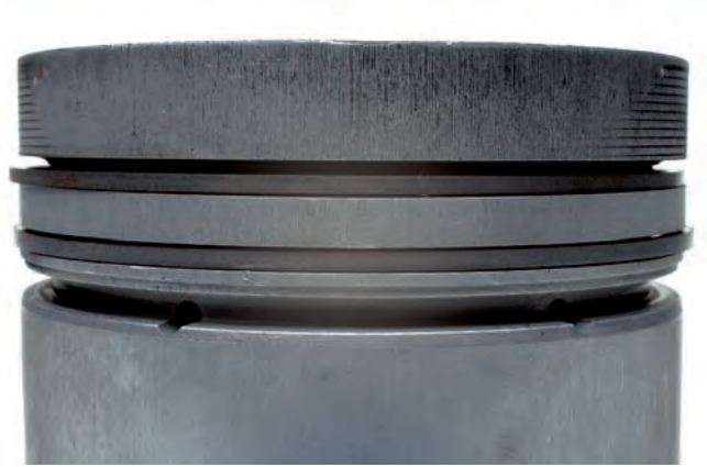
Abb. 4 Axialverschleiß der Kolbenringe
