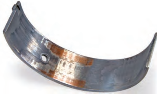
Abb. 1 Ungleichmäßiger Verschleiß an den Lagerschalen, Laufsicht zum Teil abgetragen
