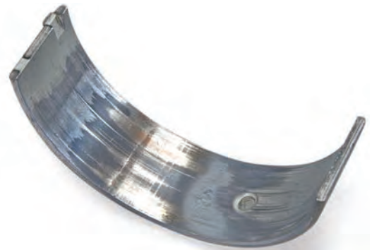
Abb. 2 Ungleichmäßiger Verschleiß an den Lagerschalen
