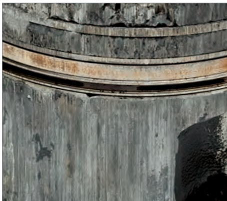
Abb. 2 Kolbenringe mit brandigen Stellen
