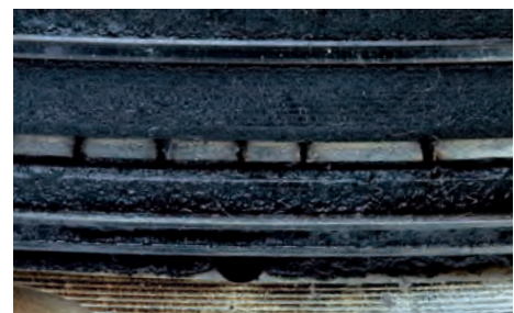
Abb. 4b Nahaufnahme eines Kolbenringbruchs
