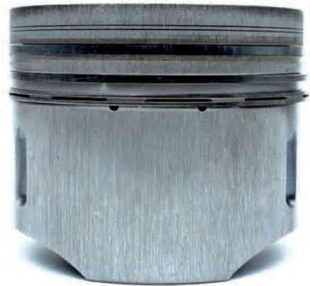
Abb. 1 Schmutzverschleiß am Kolben – starke Riefen in Längsrichtung
