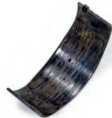
Abb. 2 Stark verschlissenes und ausgeschlagenes Gleitlager
