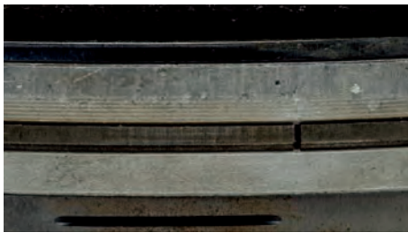
Abb. 1 Starker Radialverschleiß bei relativ geringem Axialverschleiß
