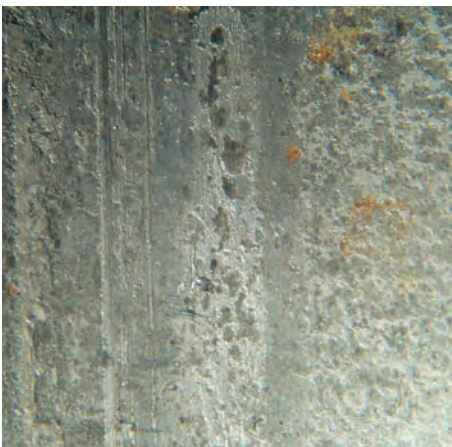
Abb. 1b In der Nahaufnahme deutlich sichtbar: das angegriffene Lagermaterial
