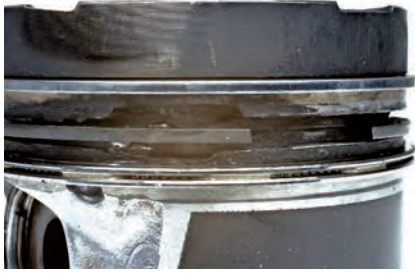
Abb. 1 Stark ausgearbeitete Kolbenringnut
