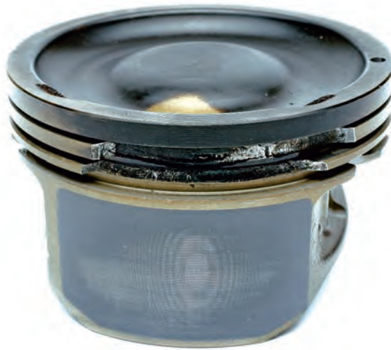
Abb. 2a Gebrochene Kolbenringstege
