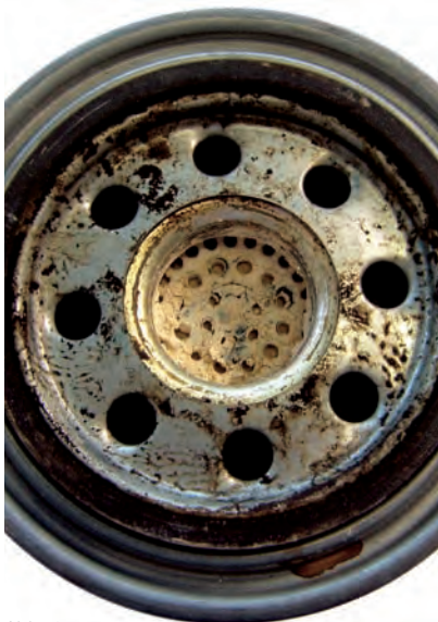
Abb. 1 Granulataustritt aus der Lufttrockner-Patrone
