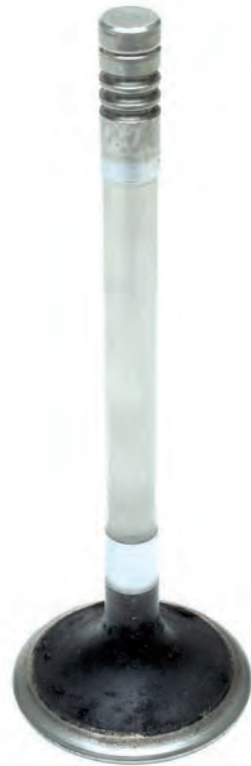
Abb. 7 Stark verschlissener Ventilschaft
