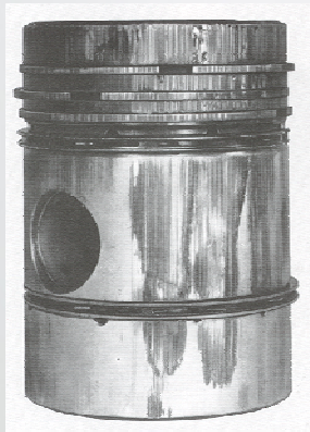
Abrasion am Kolben durch Partikel > 1 \mu\text{m}
