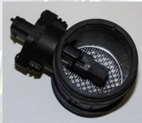
Ablagerung von Partikel auf dem Luftmassenmesser → Drift des Ausgangssignals
