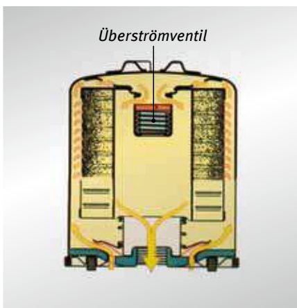
Motor in Betrieb: Rücklaufventil offen
