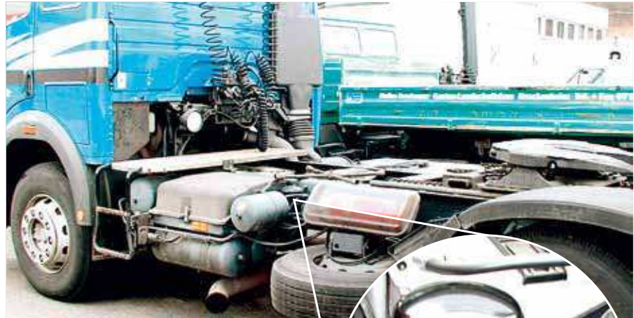
Einbauposition des Lufttrockners
