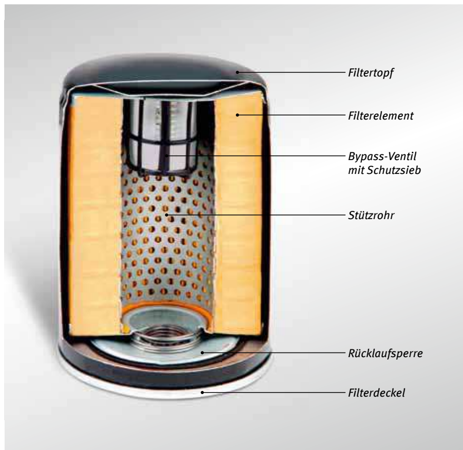
Aufbau eines Öl-Anschraubfilters
