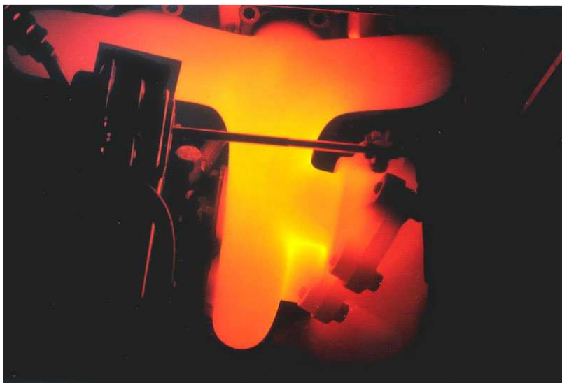
Bild 1 Turbolader erreichen je nach Ausführung Dauerdrehzahlen von 50.000 1/min bis 300.000 1/min und Temperaturen von bis zu 1.050 °C.
