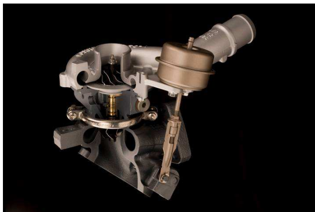
Bild 8 Schnittbild eines Turboladers mit einem Bypassventil.
