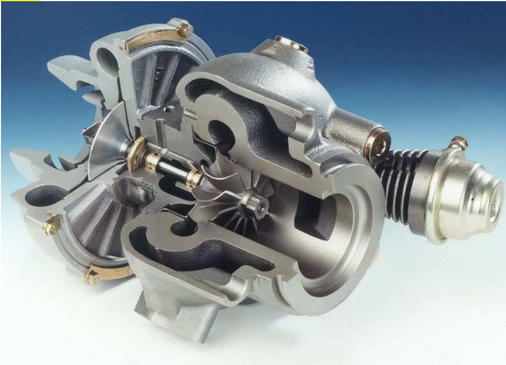
Bild 5 Ein Turbolader kann Drehzahlen bis zu 300.000 1/min erreichen. Diese enorm hohen Drehzahlen können nur erreicht werden, weil die Turboladerwelle in einem hydrodynamischen Gleitlager gelagert ist.
