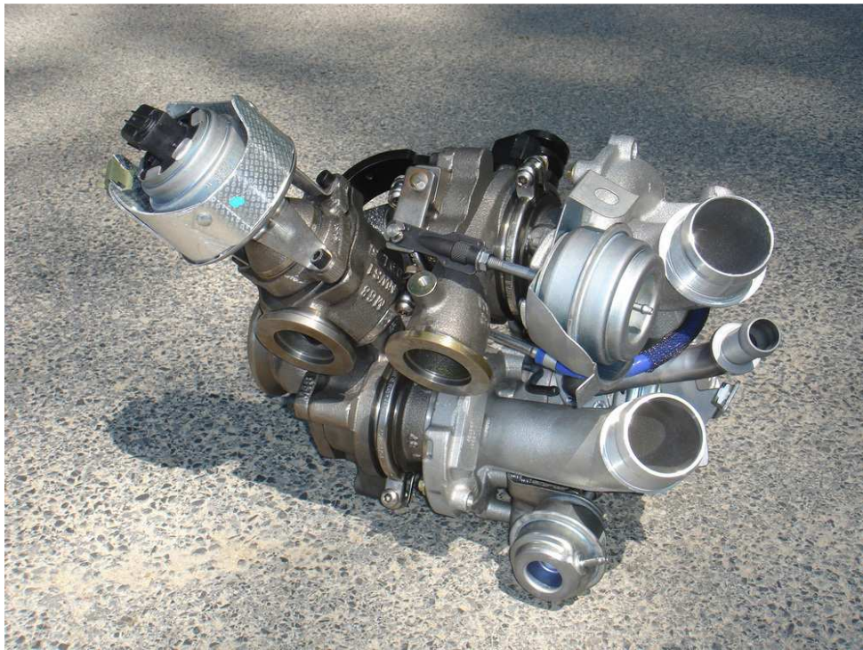
Bild 22 Beim 2,2 L Vierzylinder (DW12) bei PSA sorgt die Doppelaufladung für günstigere Abgasemissionen.
