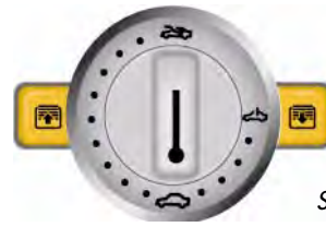
Drehschalter in der Dachelektronik vorn mit E 437- Taster für Sonnenrollo/Schiebedach
