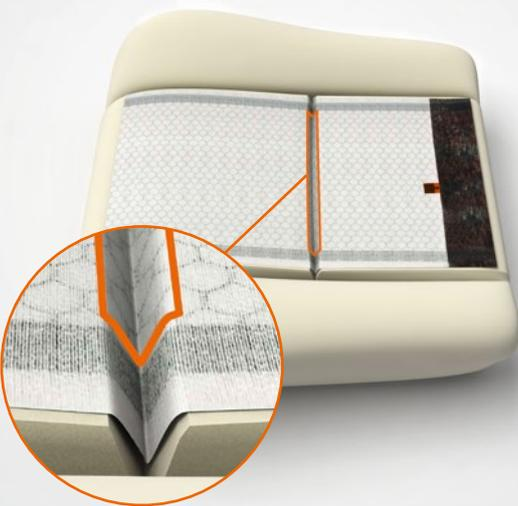
08. Legen Sie die Heizmatte mittig auf das Schaumteil, so dass diese keinen Kontakt zu den seitlich verlaufenden Abspanndrähten hat. Die Heizmatte darf keinen Kontakt mit dem Sitzgestell haben. Wurde die Heizmatte in der Länge gekürzt, so legen Sie das Ende nicht in einen Abspannkanal ein. Isolieren Sie die Schnittkante am Ende mit Klebeband ab.
