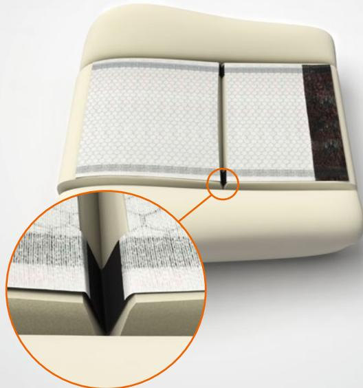
16. Bevor Sie den Bezug wieder befestigen, sollte der Abspanndraht gekürzt werden, so dass er zwischen dem Plus- und Minusleiter liegt und somit diese nicht berühren oder durchscheuern kann.
