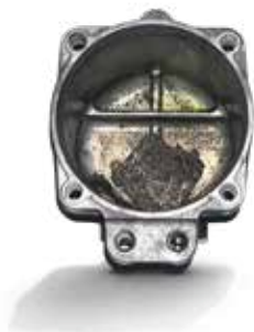
Abrieb bei Klimakompressorschaden
