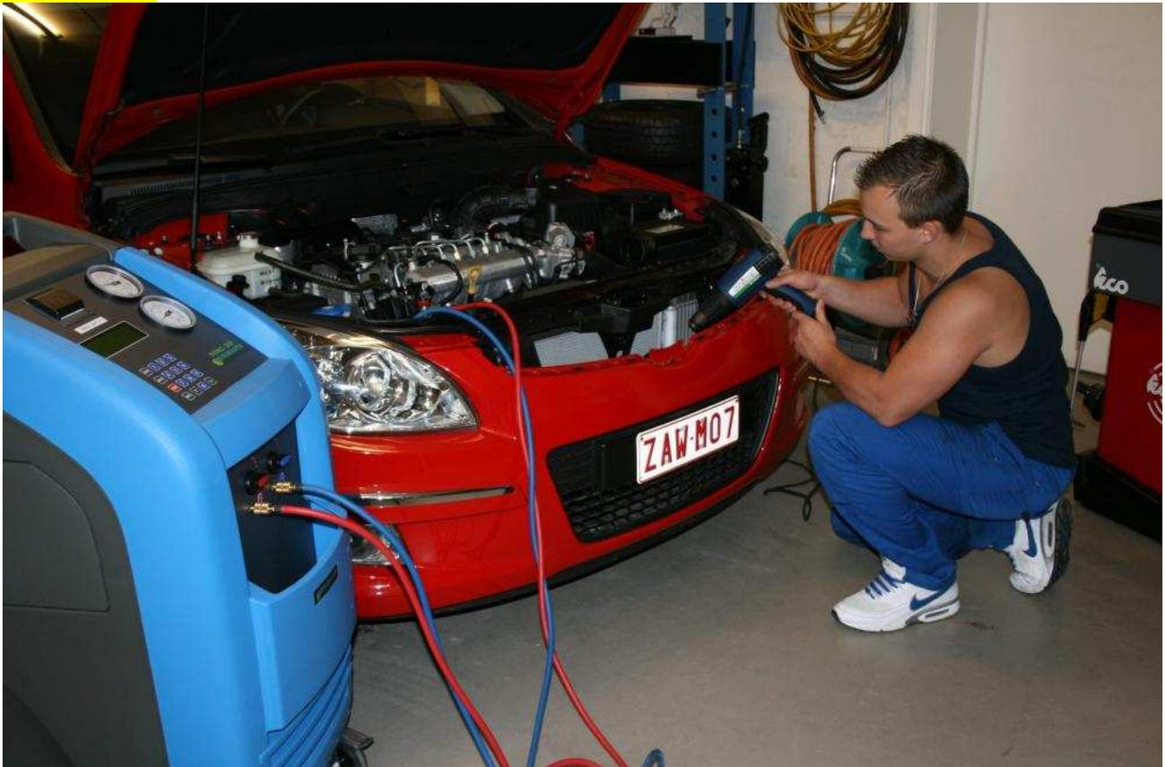
**Bild 1** Ein Klima-Service erfordert die notwendige Aufmerksamkeit. Vor allem bei immer kleiner werdenden Klimaanlage ist es äußerst wichtig, die Klimaanlage sorgfältig zu leeren. Ansonsten ist die Gefahr einer Überfüllung der Klimaanlage mit möglichen Folgeschäden groß. Das zusätzliche Erwärmen des Filter-Trockners unterstützt die vollständige Entleerung.
