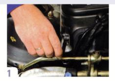
Mehrfach-Messgerät Die Verschlusskappen der Hoch- und Niederdruckleitungen werden geöffnet.
