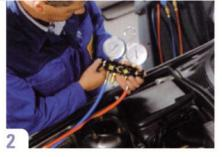
Nach Eindrehen der Rändelschrauben an den entsprechenden Ventilen kann der Druck der Anlage geprüft werden.
