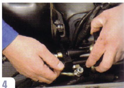
4 Befestigungshalter und Konus passen auf alle gängigen Rohrleitungsquerschnitte.
