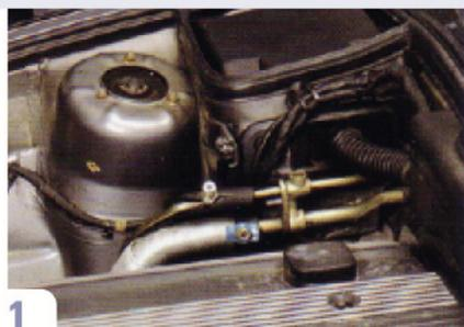
1 Klimaanlage entleeren. Leitungsverbindungen zum Verdampfer (Eingang und Ausgang) müssen geöffnet werden, damit das Schlauchsystem des Spülsets angeschlossen werden kann.
