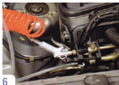
6 Dichte Verbindung von Spülpistole und Leitung durch das Prinzip Konusanschluss und festgeschraubtem Befestigungshalter.
