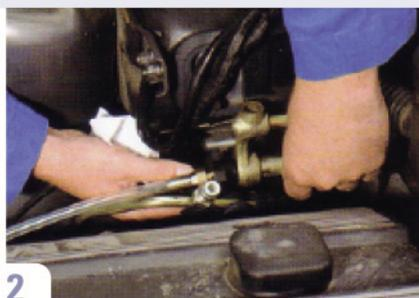
2 Geöffnete Leitung. Ein eventuell dahinter befindliches Expansionsventil/ Festdrosselventil muss entfernt bzw. gebrückt werden.
