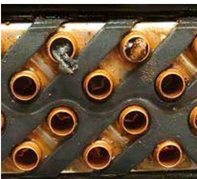
Emulsionsartige Ablagerungen im Wärmetauscher mit Turbulenzeinlagen
