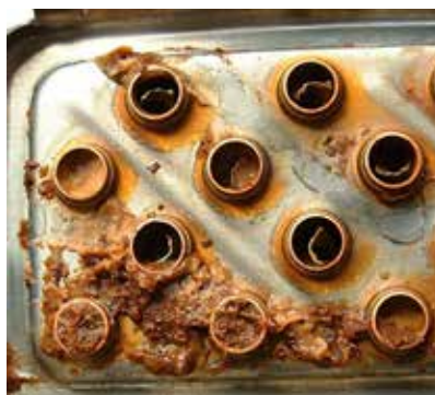
Emulsionsartige Ablagerungen im Wärmetauscher mit Turbulenzeinlagen
