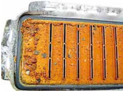
Korrosionsbildung durch falsches bzw. überaltertes Kühlmittel
