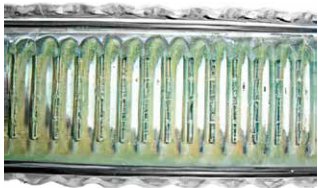
Kalkablagerungen im Kühler
