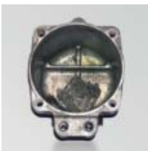
Abrieb bei Kompressorschaden
