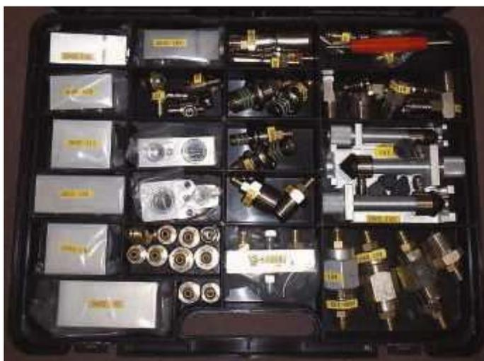
**Bild 3** Spüladapterset zum Spülen aller Klimaanlage des Typs R134a. Diese Adapter erlauben das Kurzschließen des Kompressors und des Expansionsventils, das Anschließen an alle Schlaucharten wodurch die verschiedenen Kreislauftteile separat gespült werden können.
