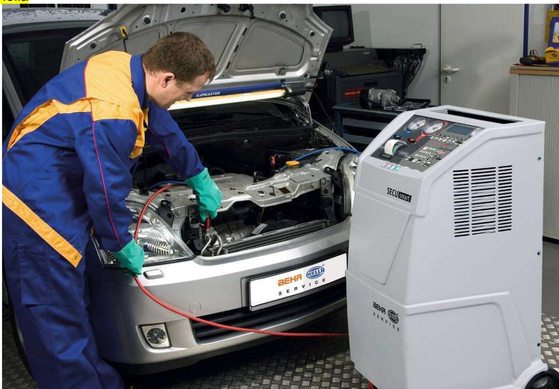
**Bild 1** Nach jedem Kompressorschaden ist das Spülen des Kältemittelkreislaufs absolute Pflicht, um alle Feststoffe aus dem System zu entfernen.
