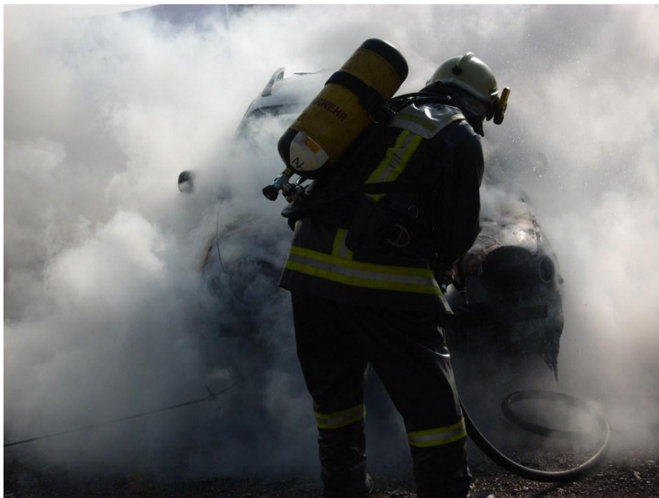
Löschung eines Pkw, bei dem sich ausgetretenes 1234yf entzündet hat. Quelle: DUH
