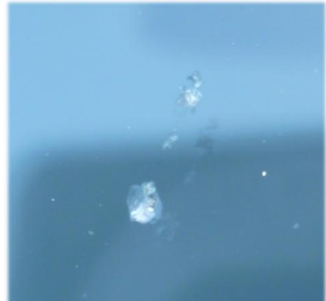
Glasschaden mit Rissbildung, eine Reparatur ist unter Einhaltung der Vorschriften möglich.
