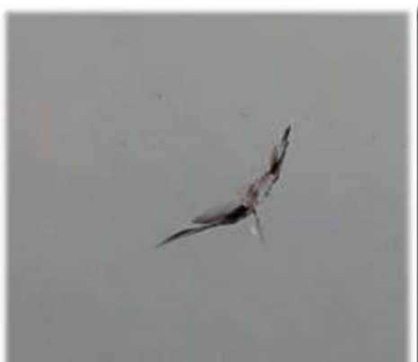
Glasschaden mit Rissbildung, eine Reparatur ist unter Einhaltung der Vorschriften möglich.
