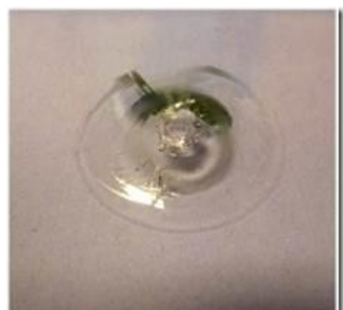
Glasschaden mit Rissbildung, eine Reparatur ist unter Einhaltung der Vorschriften möglich.
