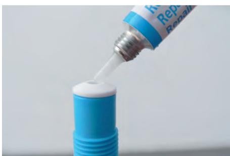
Öffnen Sie eine Packung **Reparatur-Harz** und entnehmen Sie den **Injektor** und die Tube mit **Reparatur-Harz**. Beachten Sie das Verfallsdatum des Harzes auf der **Reparaturpackung**.
