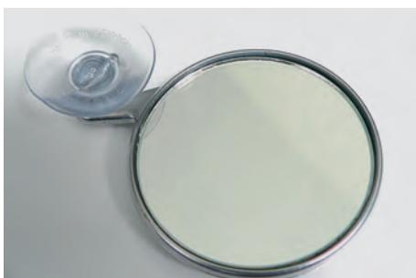
Der **Kontrollspiegel** ist vergrößernd und wird zur Beobachtung des Reparaturablaufs auf der Innenseite der Scheibe befestigt.
