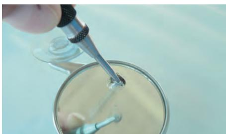
Den Sauger des **Kontrollspiegels** mit **Vakuumgel** einreiben. Den **Kontrollspiegel** so von innen an der Scheibe befestigen, dass der Arbeitsablauf von außen überwacht werden kann.
