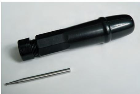
Mit dem **Steinschlagöffner** wird loses Glas entfernt. Er besteht aus dem **Handgriff** und dem **Feinfrässtift**. Durch einfache rechts-links-Drehbewegung wird der Einschlagkrater aufgebohrt, vergrößert oder auch tiefer gebohrt.
