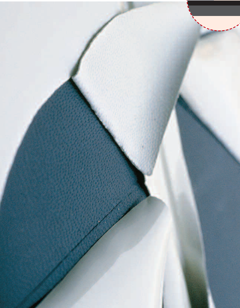
Haftungsstörung durch ungenügende Reinigung der Kunststoffoberfläche, 2-fache Vergrößerung
