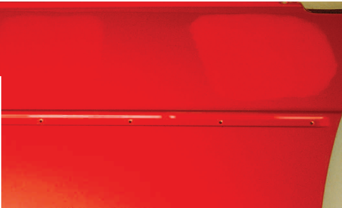
Beispiel: Zwei Füllerflecken (Tönfüller links) und ein beiger Füller (rechts) mit einem Spritzgang rotem Decklack überlackiert. Der Tönfüllerfleck wird mit dem zweiten Decklackspritzgang abgedeckt
