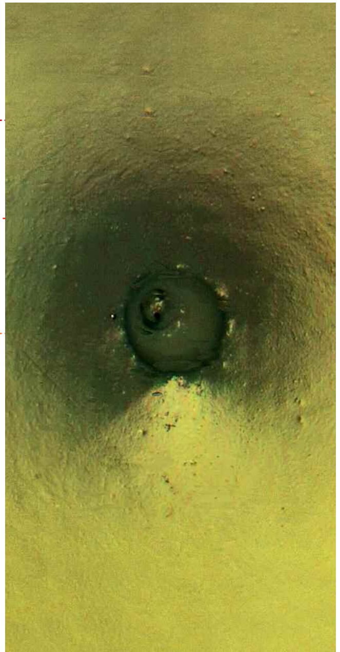
Nadelstich durch Pore im Kunststoff, 20-fache Vergrößerung
