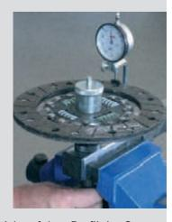
Die Kupplungsscheibe muss sich auf dem Profil der Getriebewelle leicht verschieben lassen.
