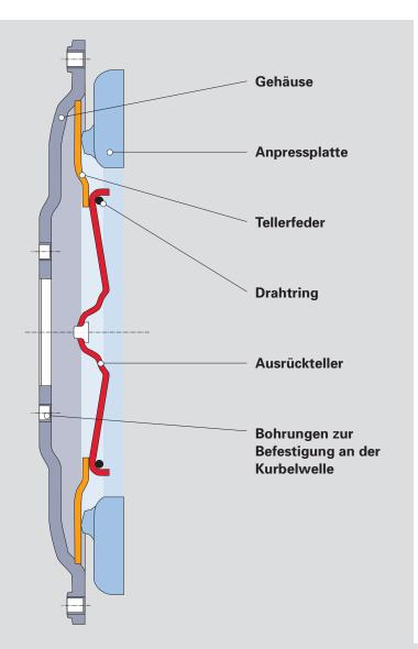
Bei dieser Kupplungsausführung ist die Anordnung von Druckplatte und Schwungmasse gegenüber einer herkömmlichen Kupplung getauscht.
