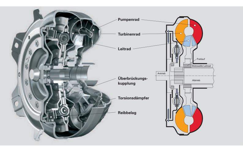
Der hydrodynamische Drehmomentwandler ist in Automatikgetrieben Anfahrelement, Übersetzungsstufe für Drehzahl und Drehmoment sowie Schwingungsdämpfer.
