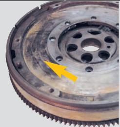
Diese werden durch missbräuchliche Benutzung der Kupplung hervorgerufen, z.B. Schleifen lassen der Kupplung:
