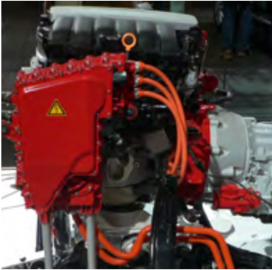
Bild 5: Basisschutz durch Isolation und Abdeckung
