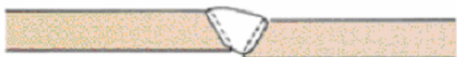
Falsch ausgeführte Schweißnaht Wurzelfehler durch versetzte Fugenflanken Abhilfe: Besseres Ausrichten vor Schweißbeginn.
