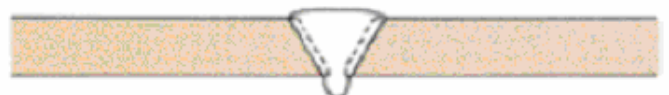
Falsch ausgeführte Schweißnaht Tropfenbildung durch unkontrolliertes Durchschmelzen. Abhilfe: Versuchen, einen kleineren Schweißeinsatz zu benutzen.
