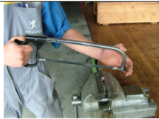
Saubere Sägeföhrung (leicht nach vorne geneigt)
