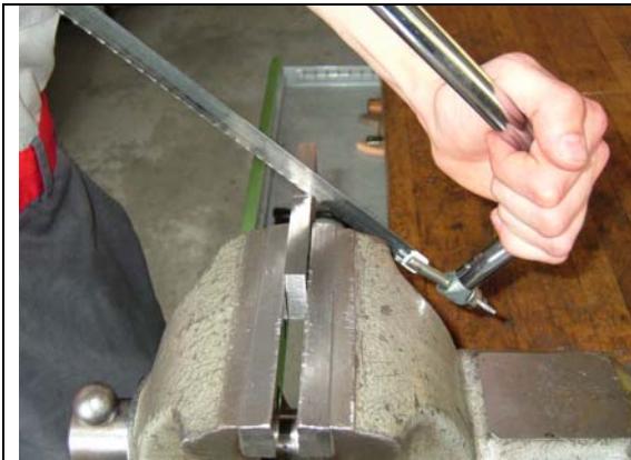
Das Sägeblatt hackt ein, (der Winkel ist zu steil).
