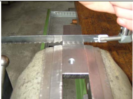
Die Auflagefläche ist zu gross, (Das Blatt kann nicht richtig fassen).
