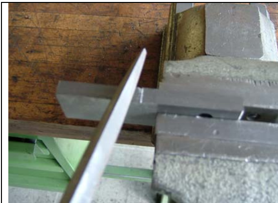
Für einen sauberen Anschnitt (mit Dreikantfeile eine Kerbe feilen).
