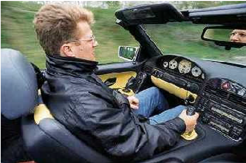
Das Foto zeigt ein Mercedes-Benz SL Versuchsfahrzeug mit Sidesticks zur Längs- und Querführung des Fahrzeugs (Foto: Daimler Chrysler)
