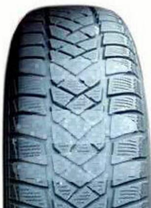
Ein Reifen, der abgenutzte Stellen in gleichmäßiger Verteilung auf der Lauffläche zeigt, leidet unter einer defekten Radaufhängung. Abgenutzte oder schadhafte Lager, Federn, Stoßdämpfer oder Achsteile, die die Auf- und Abwärtsbewegungen des Rades beeinflussen, erzeugen zusätzliche Kräfte, die auf das Rad wirken. Dadurch wiederholt sich der zusätzliche Druck genügend oft an den gleichen Stellen, um Abnutzungserscheinungen hervorzurufen, wie sie die Abbildung zeigt.
