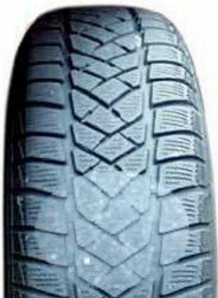
Eine einzelne Verschleißstelle in der Mitte der Lauffläche ist normalerweise auf eine Vollbremsung mit blockierenden Rädern zurückzuführen. Die Abbildung zeigt eine solche besonders in Anspruch genommene Stelle.
