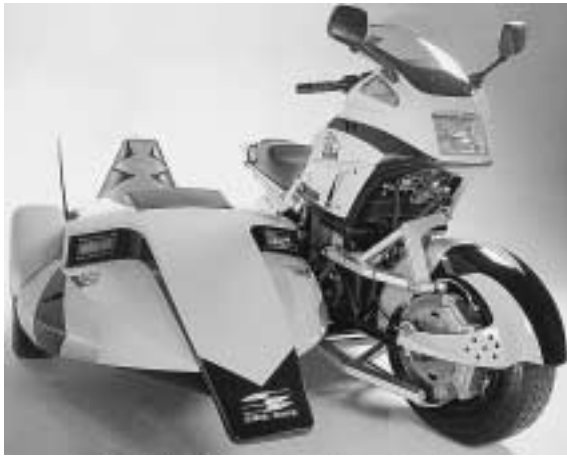
Abb. 49 Gespann, achsschenkelgelenkt Auf Yamaha-Technik basierendes Comanche-Gespann von Side Bike mit Achsschenkellenkung der Zug- maschine und des Seitenwagen- rades. Um 1994.
