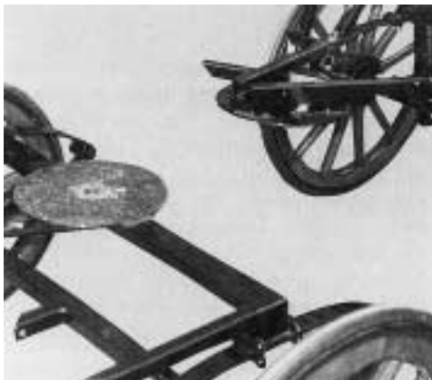
Abb. 17 Kugeldrehkranz-Lenkung Drehkranzlenkung mit rillengeführten, käfiglosen Stahlkugeln zwischen Ober- und Unterring. Schmiernippel zum Abschmieren, Mittenbolzen entfällt. Um 1990.
