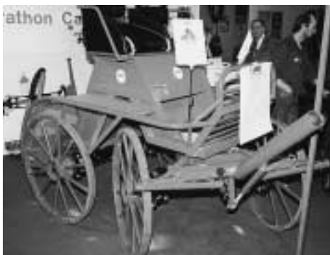
Abb. 18 Marathonwagen mit Kugeldrehkranz-Lenkung Mit den Kugellager-Drehkränzen konnte die Reibung so weit herabgesetzt werden, daß zumindest bei Marathonwagen unerwünschte Schwenkbewegungen der Deichsel durch Reibbeläge wieder abgebremst werden mußten. Um 1995.
