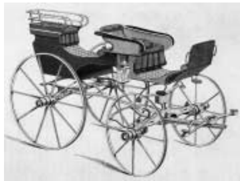
Abb. 37 Phaeton à la mode Als einen der Vorteile der Achsschenkellenkung pries Lankensperger die Möglichkeit, große Vorderräder einbauen zu können. Davon ist bei der Darstellung dieses Phaetons mit ‚beweglichen Achsen‘ kein Gebrauch gemacht worden.
