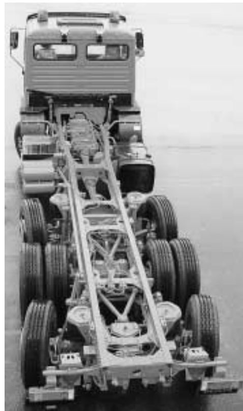
Abb. 50 Tatzelwurm, stangengelenkt Umbau eines MAN-Lastwagenfahrwerks, serienmäßig mit lenkbarer Vorderachse und starrer, zwillingsbereifter Antriebsachse, auf zwangsgelenkte Vor- und Nachlaufachse. Vorteile: höhere Nutzlast und Wendigkeit. Maurer 1996
