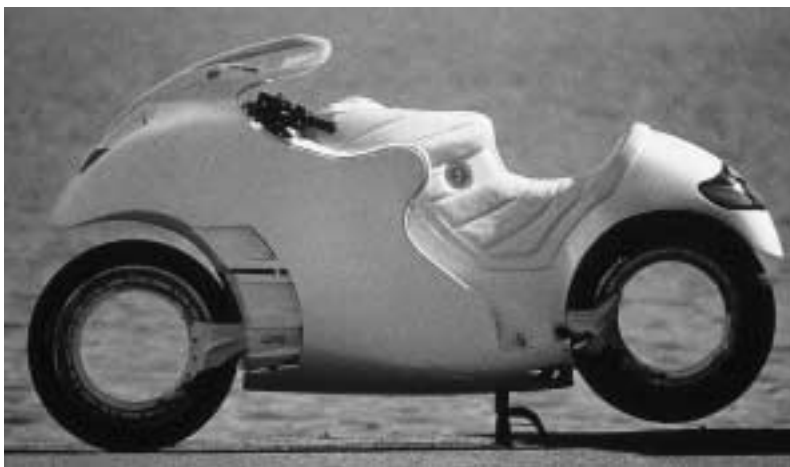
Abb. 30 Ringradlenkung Auf eine Felge mit Ring reduziertes Rad von Sbarro, bei dem, wenn der Lenkarm über der Radaufstandsfläche angreift, der wirksame Hebelarm für Störkräfte auf ein Minimum verringert werden kann. Schweiz 1989.
