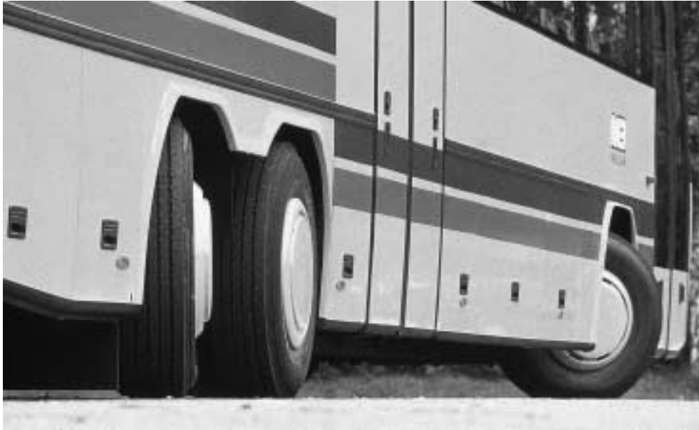
Abb. 51 Langversion, elektronisch gesteuert Dank elektronischer Lenksysteme lassen sich 15 m-Busse ähnlich behende im Stadtverkehr bewegen wie die üblichen 12 m-Linienbusse. Auch die Sicherheit wird erhöht, weil die Elektronik schneller reagiert als der Mensch und schleudernde Busse stabilisieren kann. Neoplan Transliner 1997.
