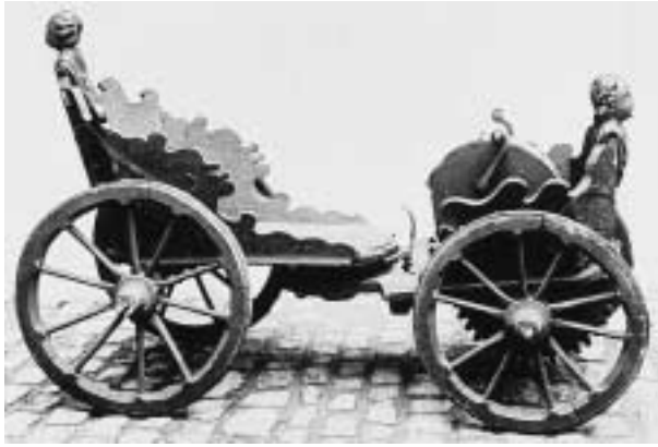
Abb. 20 Knicklenkung bei Muskelkraftwagen Farflers zweiter Wagen, diesmal vierrädig, mit Sitzfläche auf dem hinteren Wagenteil. Richtungsänderungen des tiefergelegten Vorderwagens wahrscheinlich durch Unterarmkraft auf die Verkleidung des Vorderachsantriebs.
