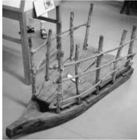
Abb. 5 Schlitten Parallelkufiger Ständerschlitten mit Pferdebespannung, Richtungsänderung durch Zugstange(n). Bayern 19.Jh.
