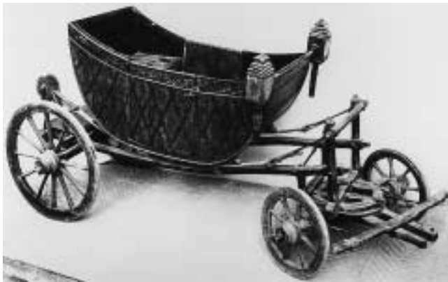
Abb. 13a Drehkranzlenkung an einem Schwellerwagen ... Kinder- oder kleiner Parkwagen mit in nachstellbaren Riemen aufgehängtem Wagenkasten. Die beiden Schweller, noch ohne Schwanenhals, stützen sich über Vor- und Ecksäulen auf dem oberen Drehkranz ab. Italien 18. Jh.
