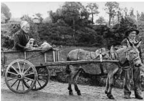
Abb. 2 Keine Lenkvorrichtung bei Einachsern Richtungsänderungen werden von dem oder den Zugtieren über Stangen auf das Gestell und auf die Achse übertragen. Die Radaufstandsfläche des kurveninneren Rades kann Mittelpunkt des vom kurvenäußeren Rades beschriebenen Kreisbogens sein. Bretagne, 19. Jh.
