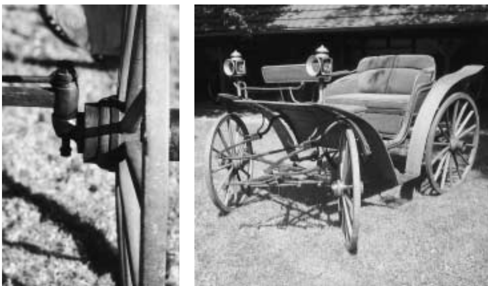
Abb. 48a+b Achsschenkelenkung nach Nitz Von Nitz gebauter Wagen von ca 1913 mit großen Vorderrädern und großem Radeinschlag, heute im Museum Achse, Rad und Wagen in Wiehl aufgehoben.
