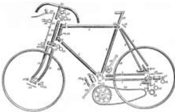
Abb. 27 Gabellenkung beim Fahrrad Zerlegte ‚Normaltype‘ der Corona-Fahrradwerke in Brandenburg mit als Rahmenkopf ausgebildetem Steuerrohr 2, in dem das Gabelrohr 25 mit Gabelkopf 26 und Gabelscheiden 41 sowie die Lenkstange 34 drehbar gelagert sind. Um 1902.
