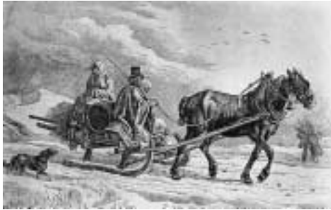
Abb. 5 Schlitten Parallelkufiger Ständerschlitten mit Pferdebespannung, Richtungsänderung durch Zugstange(n). Bayern 19.Jh.
