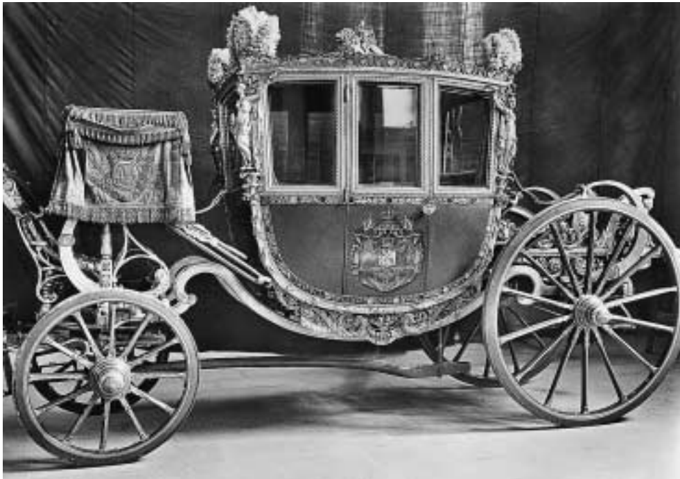
Abb. 52 Erster Münchner Krönungswagen 1813 Gala-Berline mit Drehkranzlenkung nach einem Entwurf von Ginzrot, erbaut von Hofwagner Lankensperger und weiteren Handwerkern und Künstlern. Der Wagen steht heute im Marstallmuseum in Schloß Nymphenburg.
