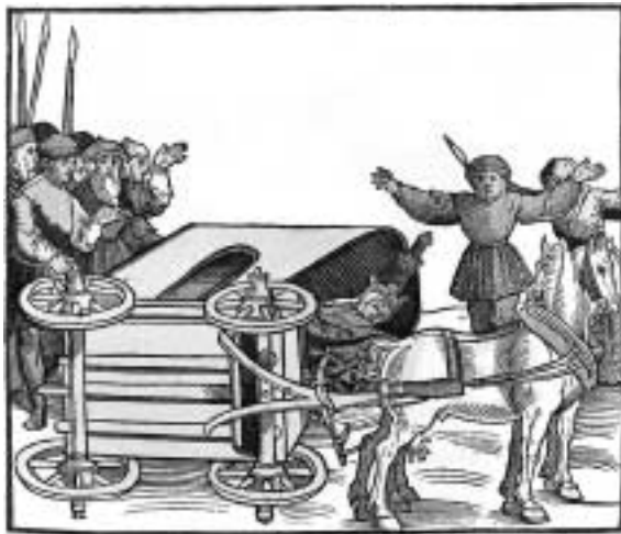
Abb. 12 Eile mit Weile Gegenpapst Johannes XXIII in seinem umgestürzten Reisewagen 1414. Zu erkennen sind Dreh- schemellenkung mit gegabelter Deichsel, Reibschiet und Reibnagel in Vorderachsmittle.
