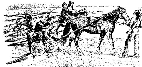
Abb. 6 Travois Die Stangenenden schleifen über den Boden, die elastischen Stangen verursachen weniger Erschütterungen als ein Wagen (den die Indianer nicht kannten).
