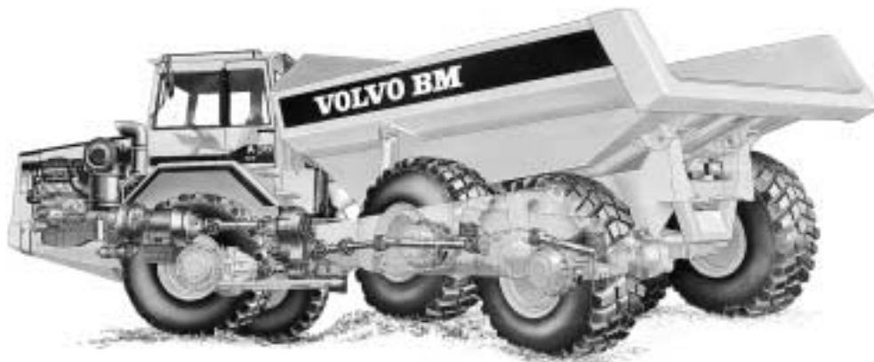
Abb. 24 Knicklenkung bei Muldenkippern 1988 Volvo BM-Dumper mit Sechsradantrieb, Tandemachse, Einzelachsaufhängung und Knickgelenk zwischen Zugkopf und Anhänger. Wendekreis etwa 15m, Nutzlast 32.000 kg.
