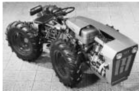
Abb. 23 Knicklenkung bei Schleppern △ 1968 Holder Cultitrac-Kleinschlepper für Reihenkulturen mit Vierradantrieb, gleichgroßen Rädern und Knicklenkung. Sie ermöglicht Lenkgenauigkeit und kleinen Wendekreis, erwünscht im Wein- und Hopfenbau, in Obst- und Zitrusplantagen, in Kaffeepflanzungen, Baumschulen und Forstbetrieben.
