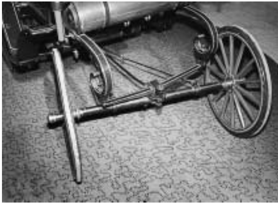
Abb. 9 Reibnagel-Lenkung an einem Motorwagen Ein verhältnismäßig schwacher Bolzen an der Vorderachse eines Daimler-Riemenwagens von 1896 mußte Biegemomenten, Scherspannungen, Flächenpressung und Druck- und Zugspannungen gewachsen sein. Auch die vom Dampfmaschinenbau übernommene Lenkkraftübertragung mit Ketten fördert nicht gerade das Vertrauen in diese Lenkconstruction.
