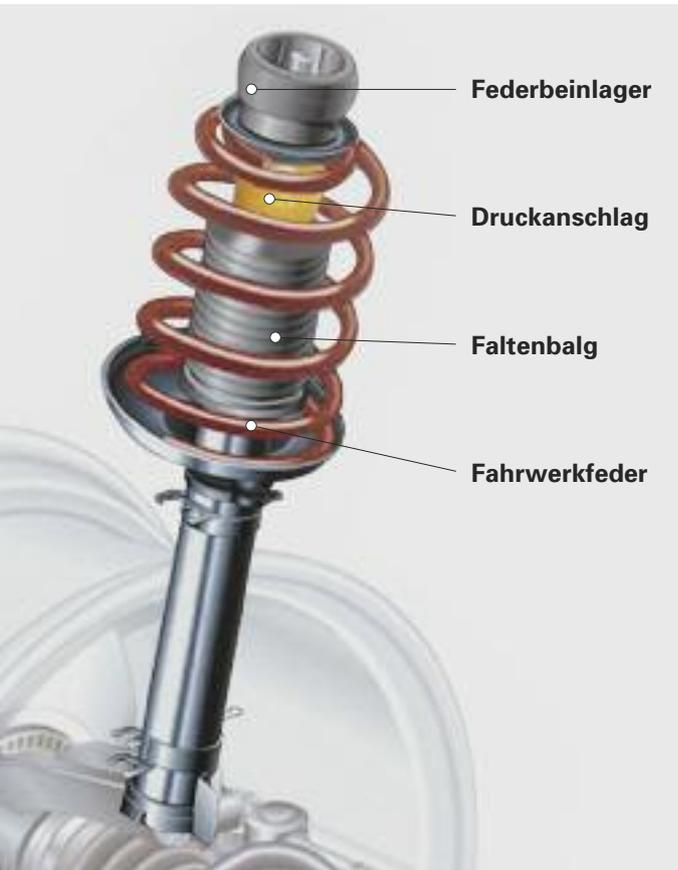
*Die Funktion der Stoßdämpfer kann nur so gut sein wie es die umliegenden Komponenten zulassen. Daher sollten bei einem Stoßdämpferwechsel unbedingt auch die Federbeinlager, Service-Kits (bestehend aus Druckanschlag und Faltenbalg oder Schutzrohr) und Fahrwerkfedern auf Beschädigungen bzw. Verschleiß überprüft werden.*
