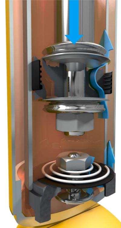
Das Bodenventil erzeugt beim Zweirohr-Gasdruck-Stoßdämpfer die Druckdifferenz, die für die Funktion (Dämpfung) relevant ist.
