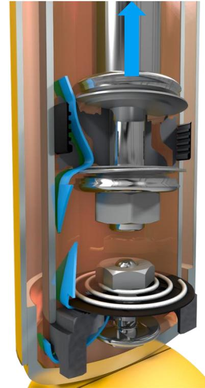
Das Kolbenventil sorgt beim Zweirohr-Gasdruck-Stoßdämpfer für die Regulierung des Ölstromes durch die Kanäle.
