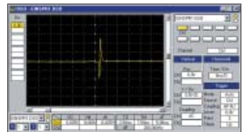
Livebild Einspritzventil mit Fehler
