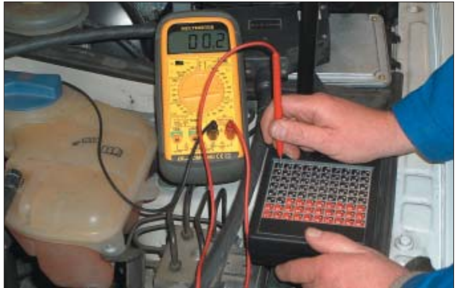
Prüfung mit der Prüfbox
