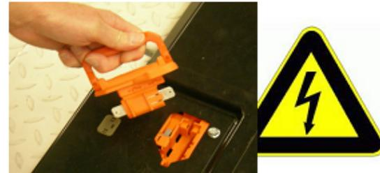
**HV Kabel** außerhalb von Gehäusen sind orangefarben zu kennzeichnen (siehe ISO/DIS 23273-3 Teil 6.2; vgl. SAE J2578 Teil 4.4.1 und 4.7). Innerhalb von Gehäusen kann auf die Kennzeichnung verzichtet werden, wenn die **Gehäuse** mit dem Symbol s.o. gekennzeichnet sind.
